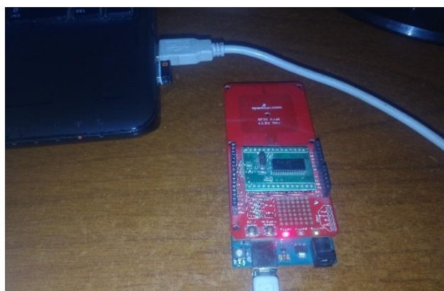
Figura 54: Conexión Modulo Arduino RFID con computador Fuente: Elaboración propia.
