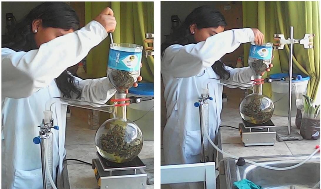
**FIGURA 6. Proceso de destilación y decantación del aceite esencial de muña.**
