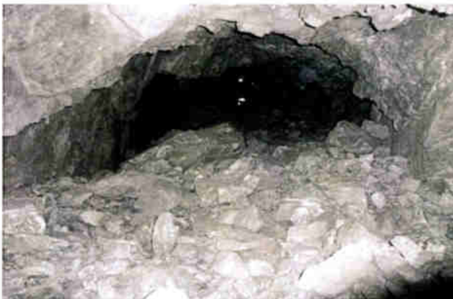
Fotografía muestra la carga rota después de la voladura masiva no eléctrica Fuente propia.
