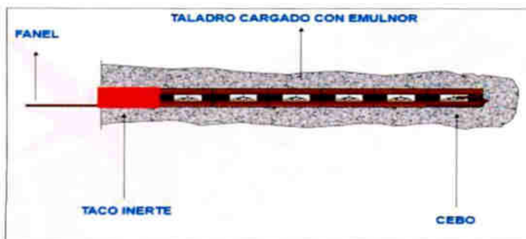
Fotografía 5. 3. Carga de la columna de taladro con accesorios no eléctricos y explosivos tipo emulsion o emulnor de 1000 y 500.
