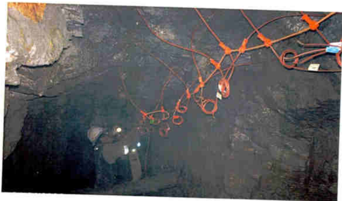
Fotografía muestra el amarre de los accesorios no eléctricos con faneles periodo corto (mininel).
