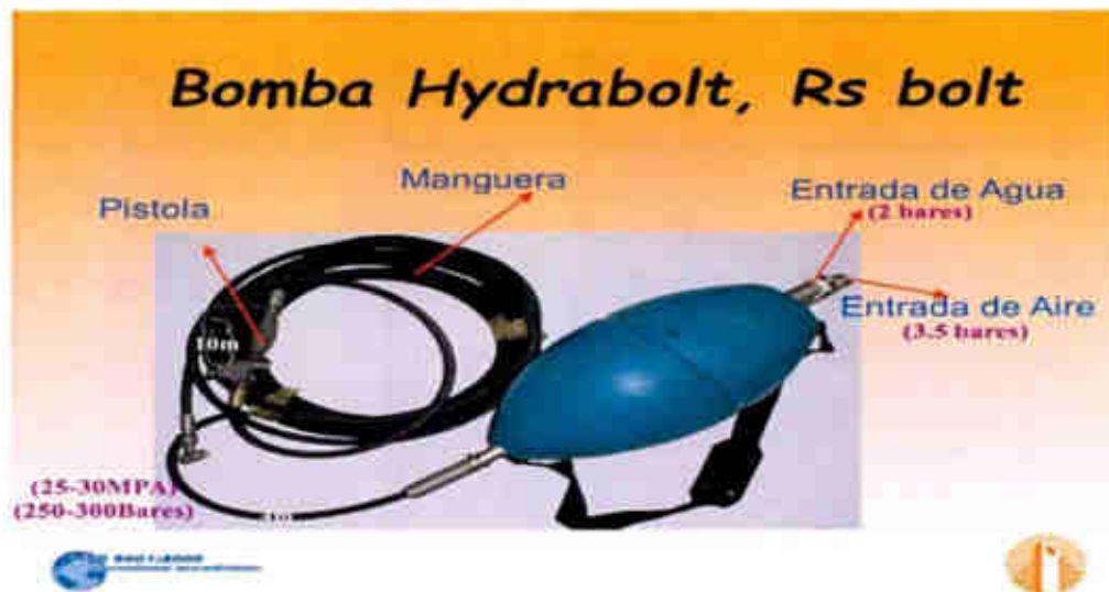
Figura 2. 9. Equipo para realizar el inflado con agua y aire a gran presión de lo "rs bolt" instalados en rocas.
