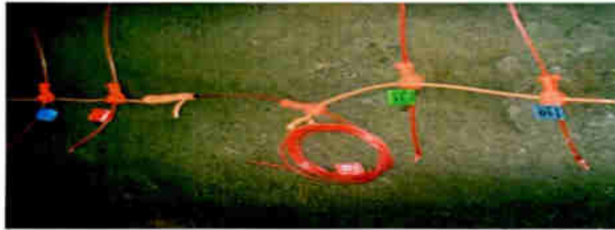
Fotografía 5. 5. Puente para una voladura masiva secuencial con accesorios no eléctricos
