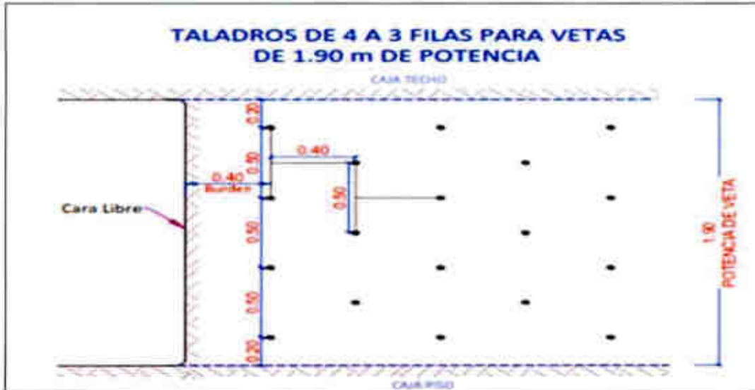
Figura 4. 13. Malla de perforación para un ancho de veta (av) de 1.90m
