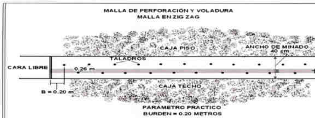
Figura 4. 14. Malla de Perforación y voladura- malla Zigzag.
