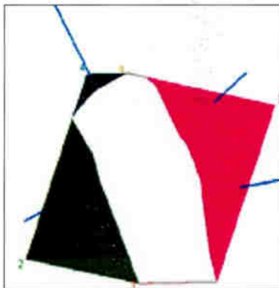
Figura 4. 8. Muestra de las cuñas con soportes "Rs bolt" en la caja techo y piso
