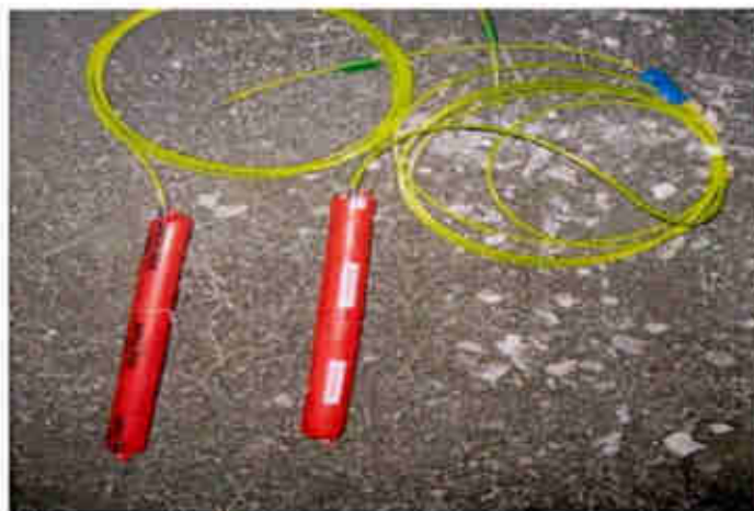
Fotografía 5. 2. Fotografía 5. 1 Prima o cebo con Emulnor 3000 el inicia toda la columna de carga explosiva en el taladro.
