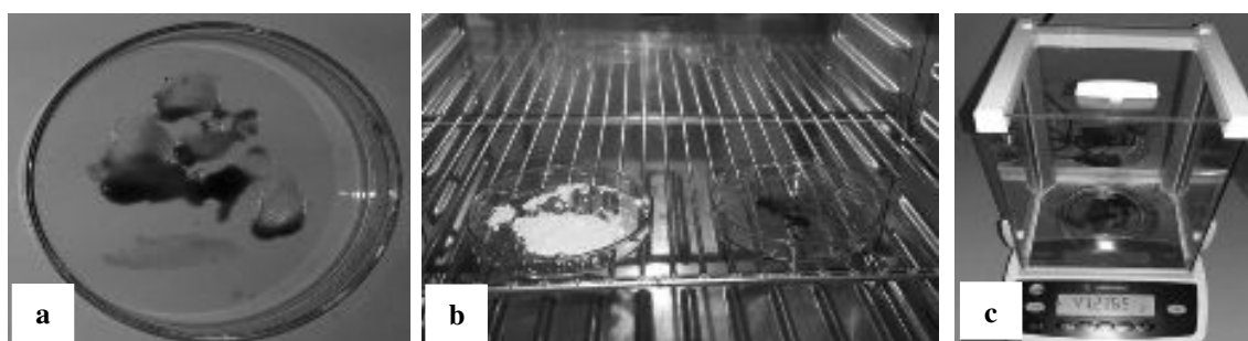
Figura 17. Fotografías de humedad: (a) EPP (b) Secado en estufa del EEP (c) Pesado del EEP.
