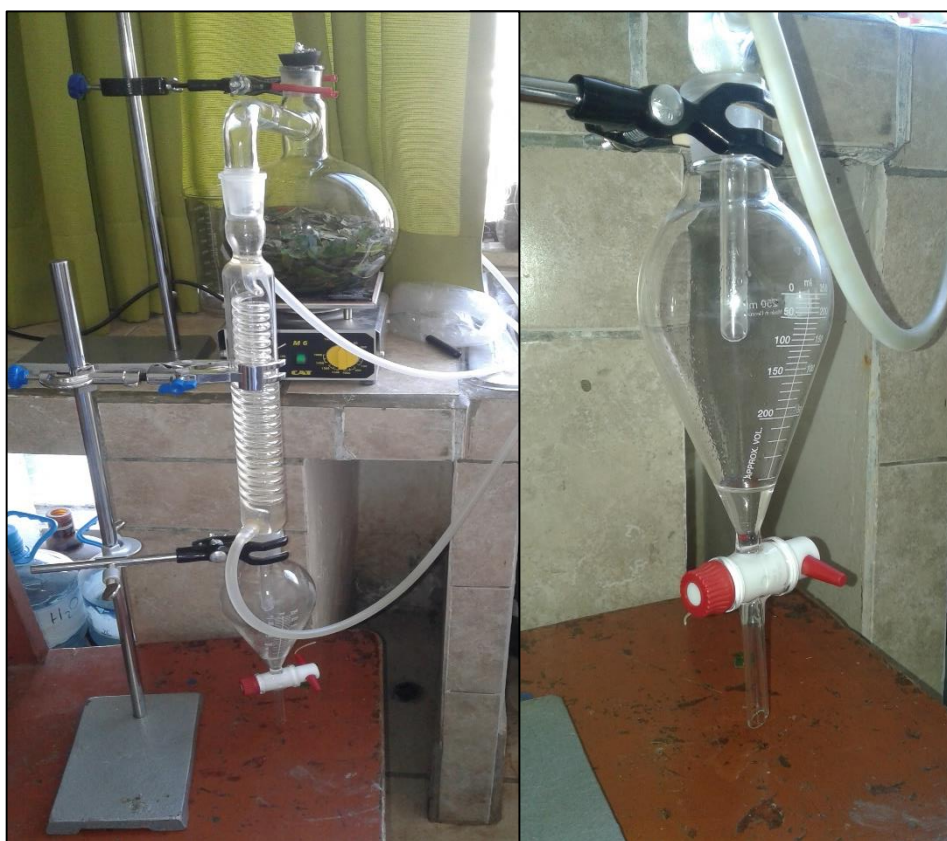
Figura 18. Izquierda equipo de destilación conformado por el balón destilador el cual contiene la materia orgánica a destilar, el condensador o refrigerante (izquierda) y la pera decantadora la cual permite la separación del aceite esencial del agua por el principio de la gravedad (Derecha).
