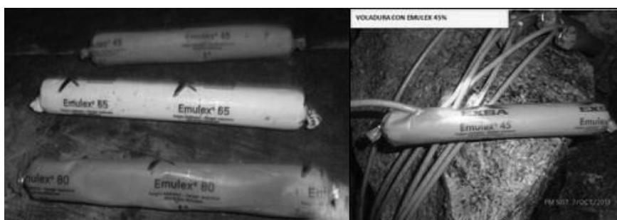
Figura 24: Explosivos usados en la voladura del tajo piloto (Anexo fotos)
