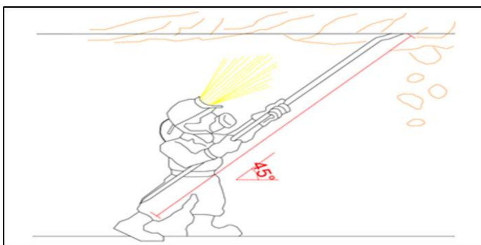
Figura 21 Posicionamiento para desatado de roca
