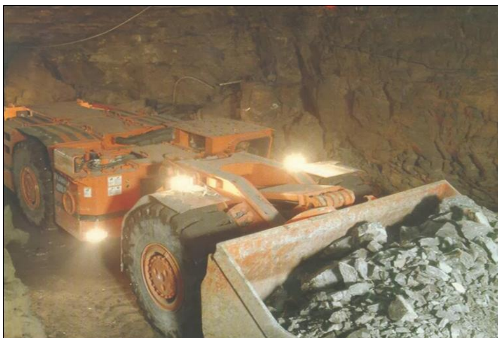
Figura 22. Transporte de material en scooptrams
