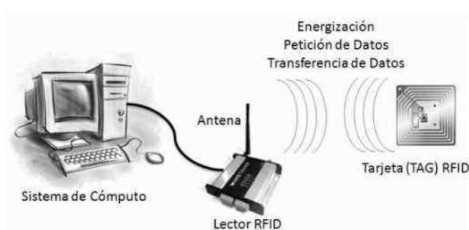
Figura 3 - Sistema básico de RFID
