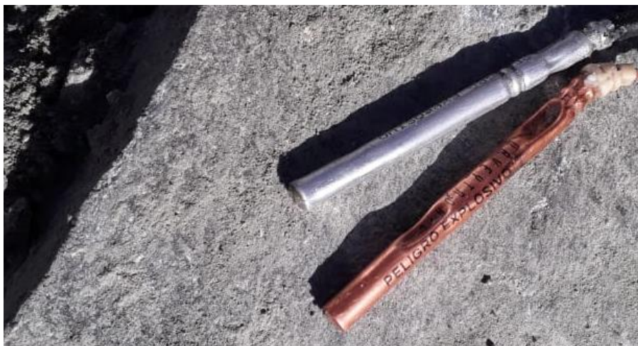
Figura 3.29: Detonador fallado por efecto de la presión dinámica. Fuente: (Area de Asistencia Tecnica - MMG Las Bambas, 2017).
