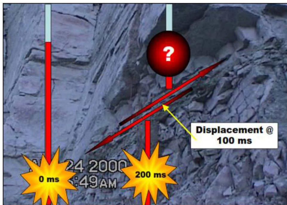
Figura 3.36: Corte debido a desplazamiento de estructuras geológicas. Fuente: (Curso de explosivos y voladura Dyno nobel , 2016)
