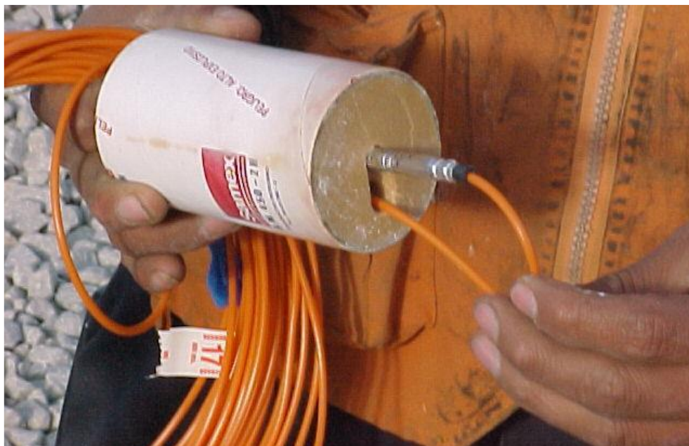
Figura 3.31: Primado de detonador pirotécnico con Booster. Fuente: ( Curso de explosivos y voladura Dyno nobel , 2016).
