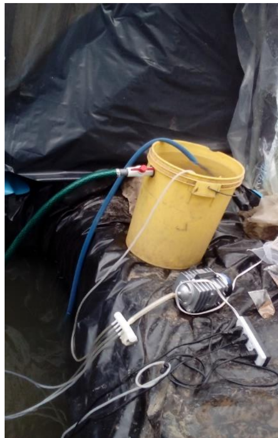
Figura 11. Sistema de aireación y filtración del efluente
