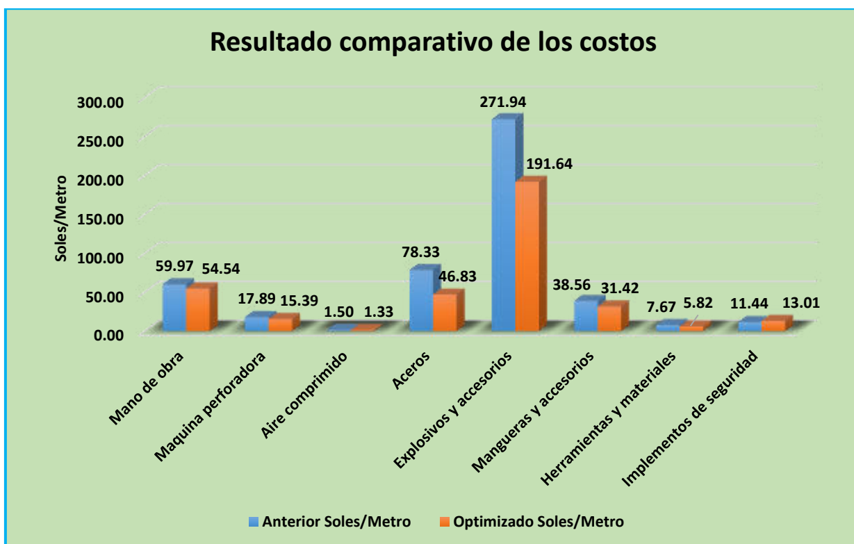
Figura 40 — Resultado comparativo de costos de perforación y voladura por ítem Ga 575 W
