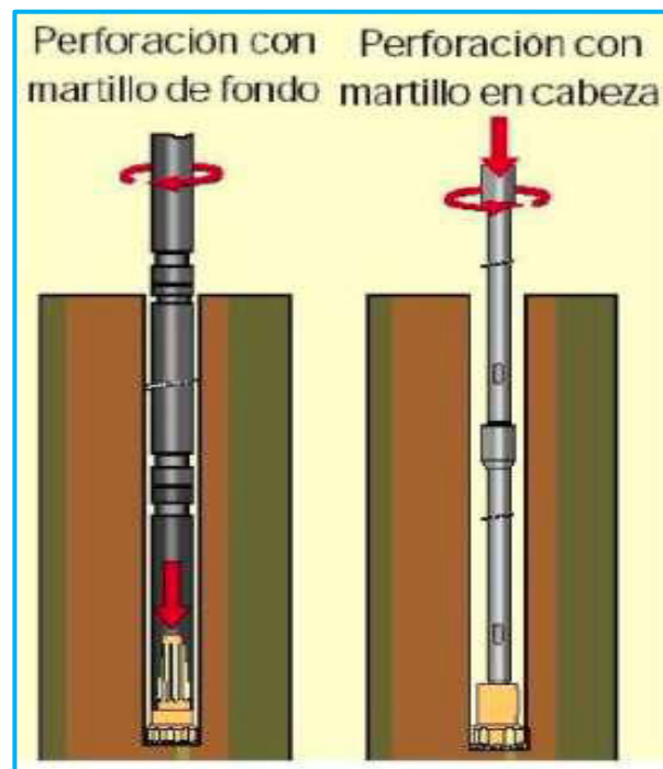
Figura 3 — Perforación con martillo de fondo y en cabeza
