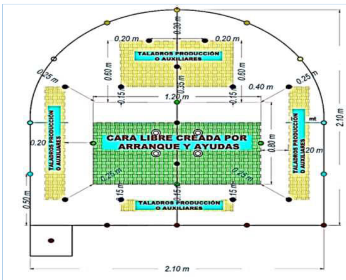
Figura 30 — Distancia óptima hacia la cara libre de los taladros de producción o auxiliar
