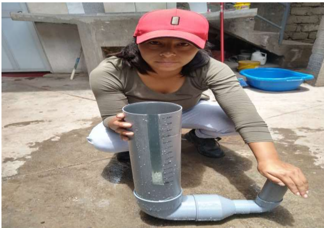
Figura 49 — Prueba de permeabilidad de los especímenes de concreto permeable
