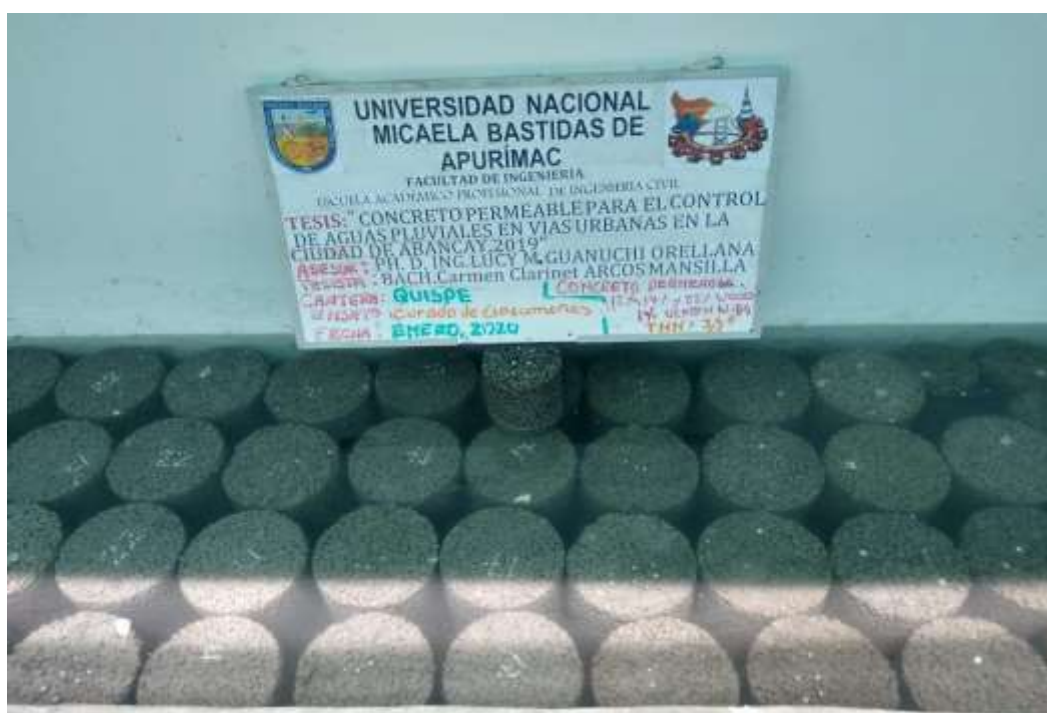
Figura 13 — Curado de especímenes de concreto permeable – tamaño N.º 8
