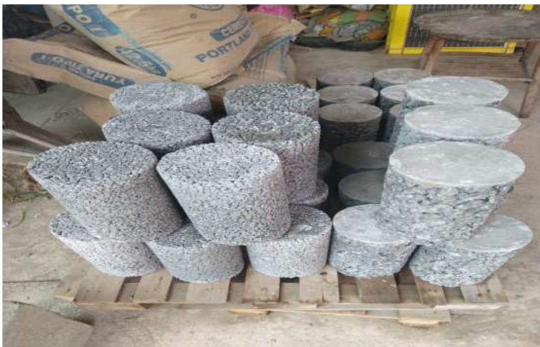
Figura 13 — Especímenes de concreto permeable de huso 8 y 67
