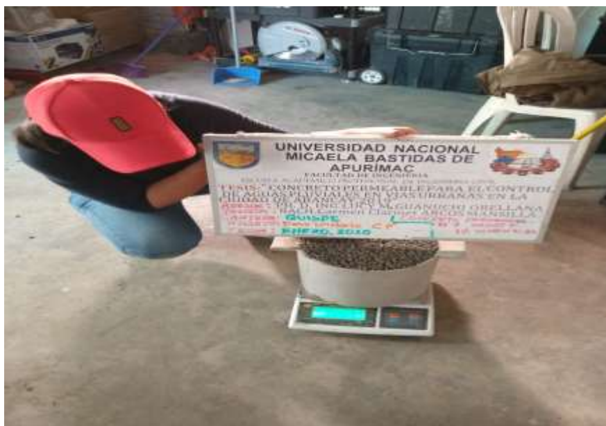
Figura 11 — En laboratorio realizando la prueba de peso unitario
