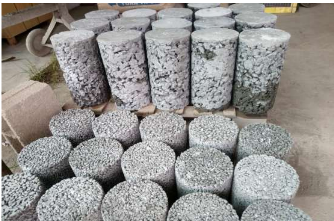
Figura 41 — Especímenes de concreto permeable para el ensayo de permeabilidad con agregado de Huso 8.
