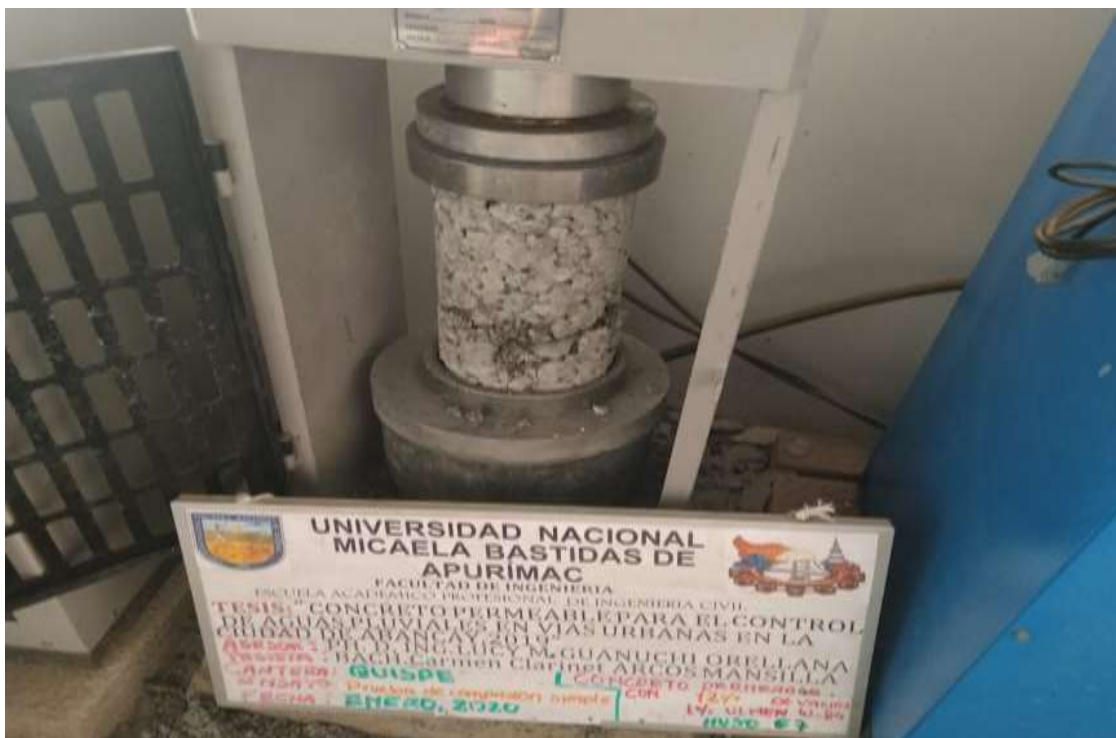
Figura 46 — Prueba de compresión simple espécimen de concreto permeable, Huso 67
