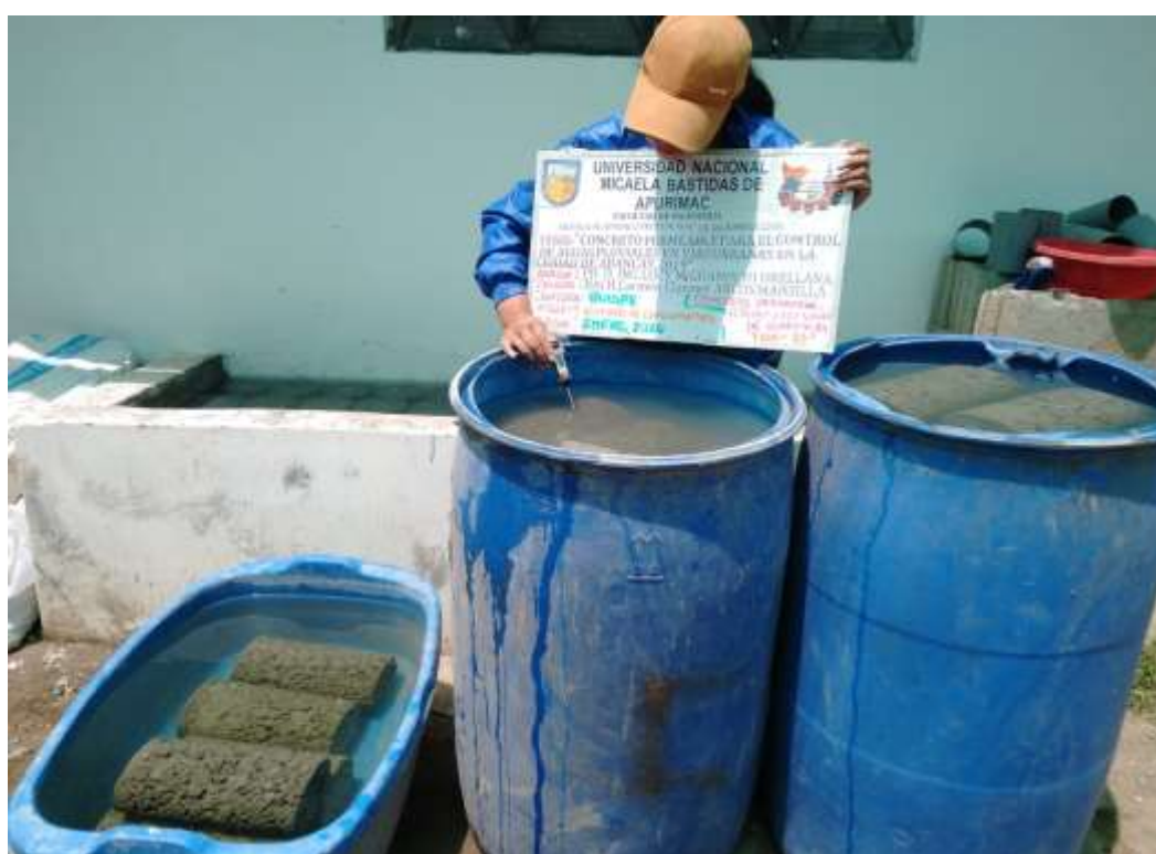
Figura 14 — Curado de especímenes de concreto permeable – tamaño N.º 67
