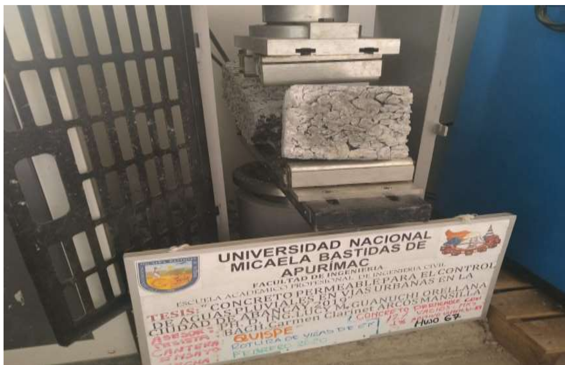
Figura 47 — Vista de falla de la viga de concreto permeable, Huso 67
