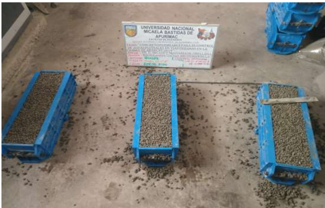
Figura 44 — Moldeado de vigas de concreto permeable con agregado de Huso 8
