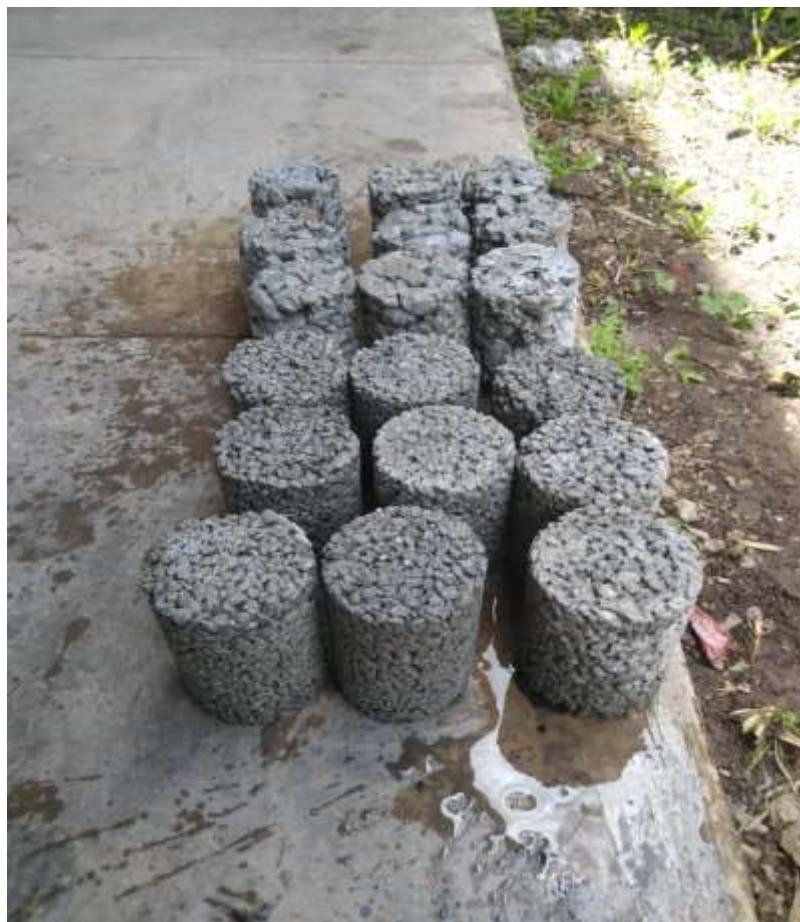
Figura 24 — El tamaño de los especímenes a utilizar es de 10.0 cm de diámetro y de 15.0 cm de altura
