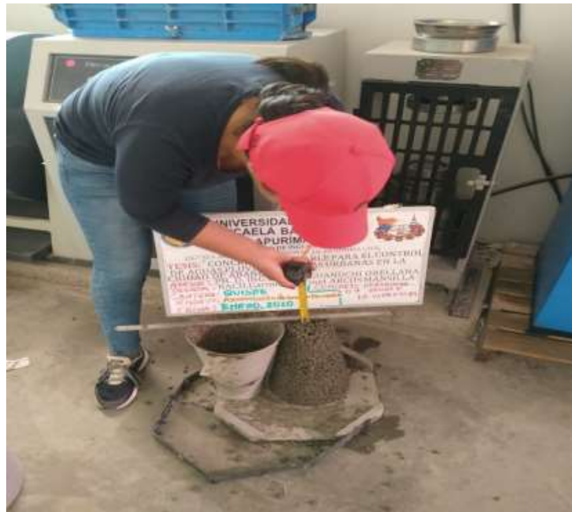
Figura 10 — En laboratorio realizando la prueba del cono de Abrams
