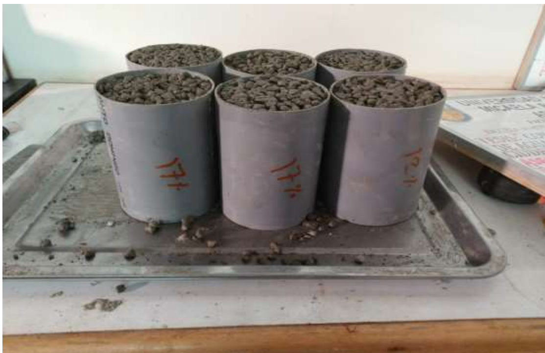
Figura 41 — Especímenes de concreto permeable para el ensayo de permeabilidad con agregado de Huso 8.
