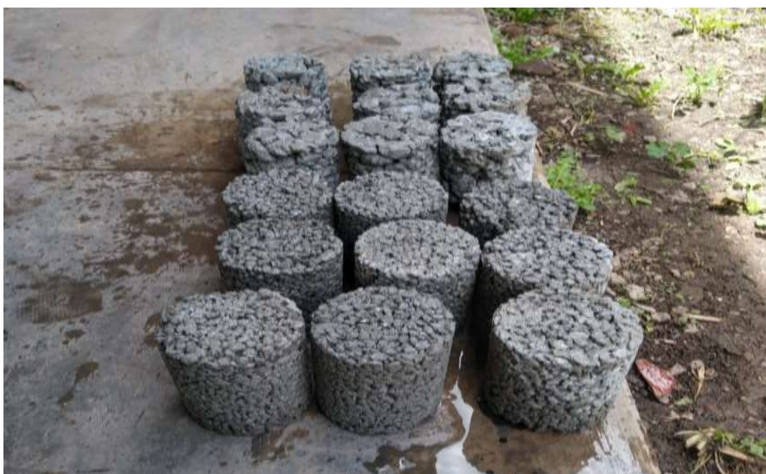
Figura 49 — Prueba de permeabilidad de los especímenes de concreto permeable
