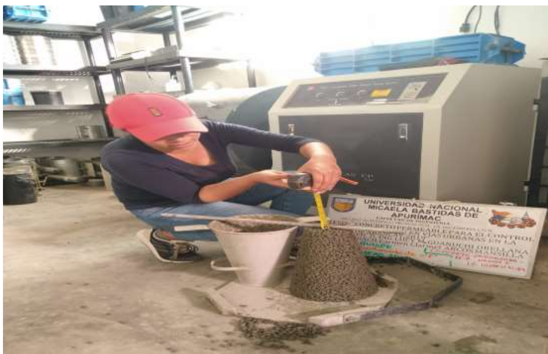
Figura 40 — Revenimiento del concreto permeable con agregado de Huso 8
