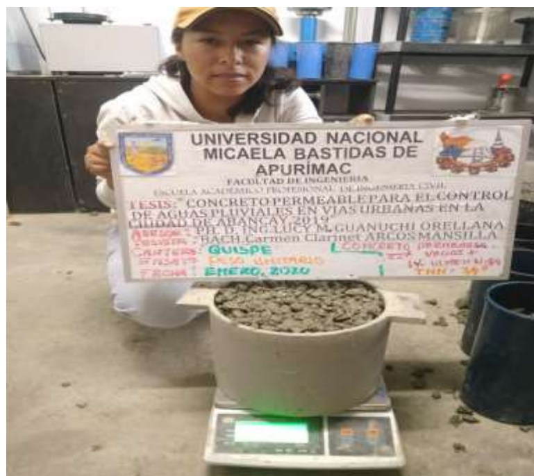
Figura 12 — Prueba de peso unitario del concreto permeable
