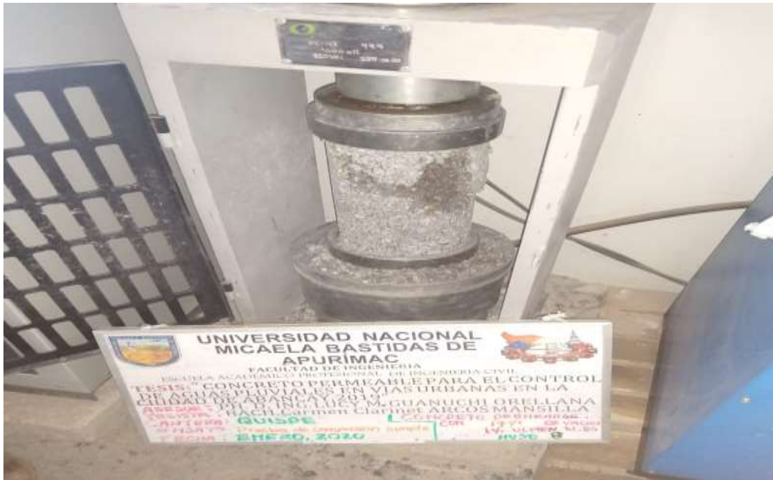
Figura 45 — Prueba de compresión simple espécimen de concreto permeable, Huso 8
