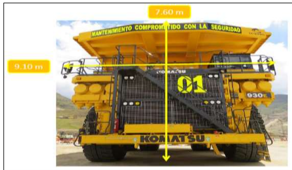
Figura 17 — Vista frontal del camión Komatsu 930E-4SE en Mina Extraído de Entrenamiento Mina – Las Bambas
