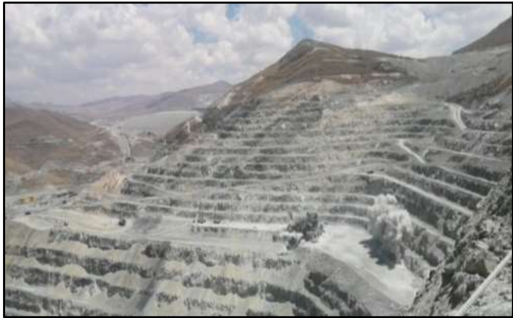
Figura 11 — Proceso de Voladura en el Tajo Ferrobamba
