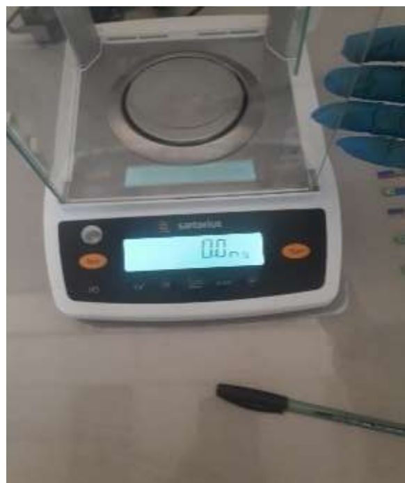
Figura 36 — Tarado de la balanza analítica 2
