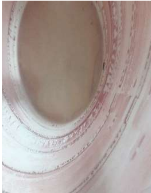
Figura 39 — Residuos de la estabilización tartárica 4
