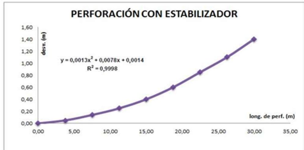
Figura 30 — Curva de desviación con estabilizadores de perforación
