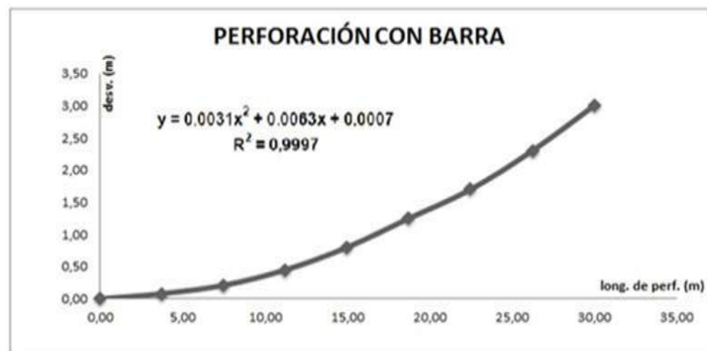
Figura 29 — Curva de desviación en la perforación con barrenos integrales o cónicos
