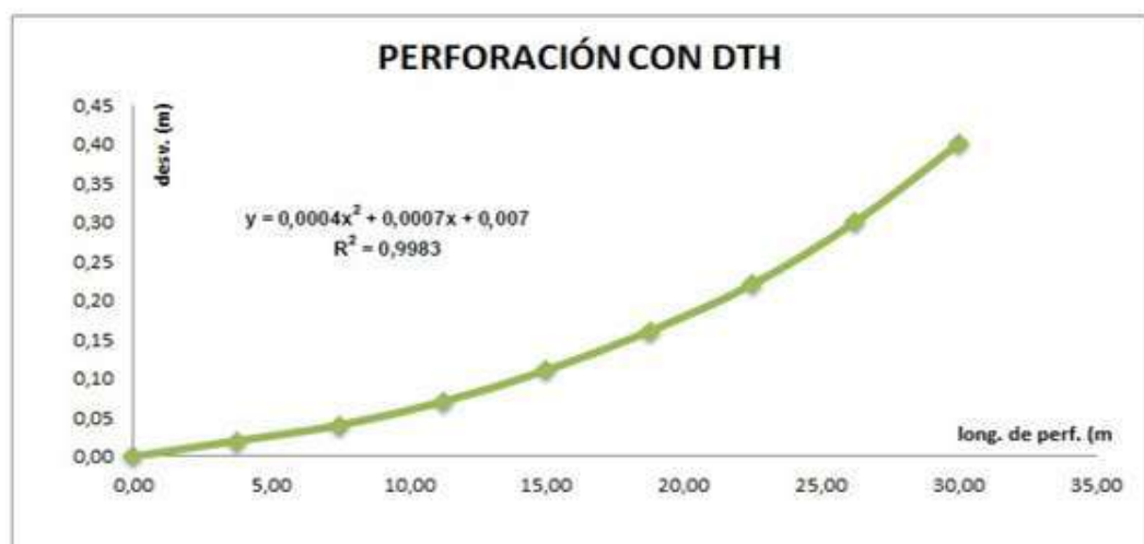
Figura 31 — Curva de desviación en perforaciones con martillos de fondo
