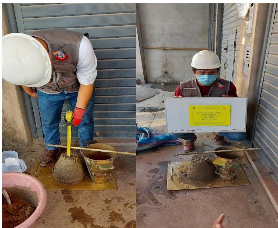
Figura 57 — Determinación del asentamiento del concreto fresco
