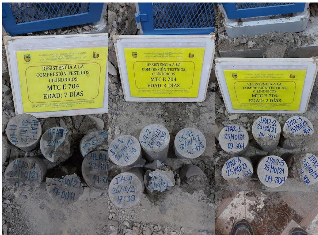
Figura 62 — Probetas de concreto después del ensayo a la compresión simple
