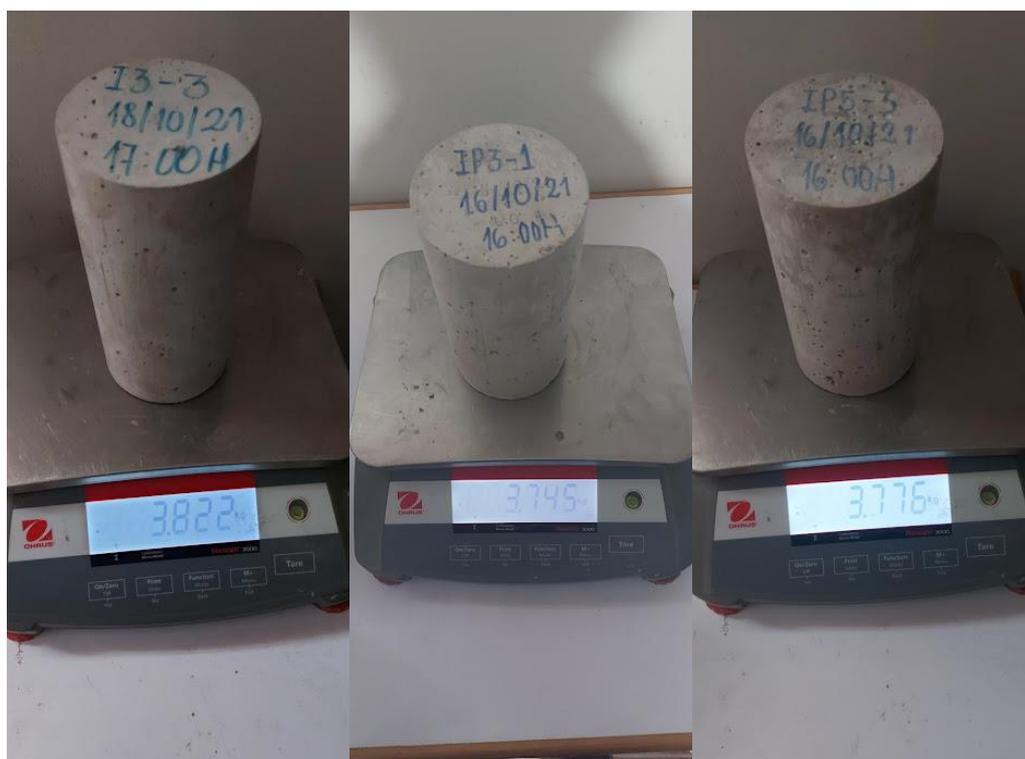
Figura 63 — Pesado de probetas de concreto antes del ensayo a la compresión simple
