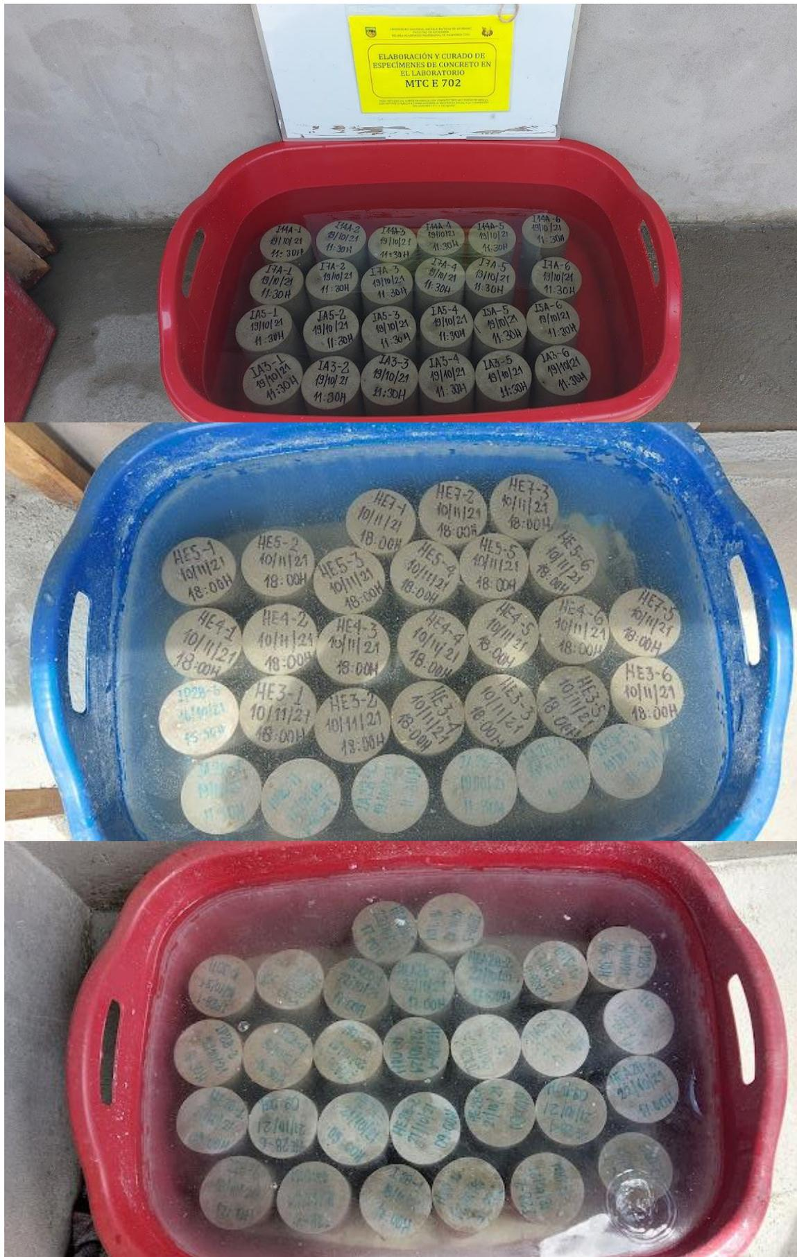
Figura 59 — Curado de concreto
