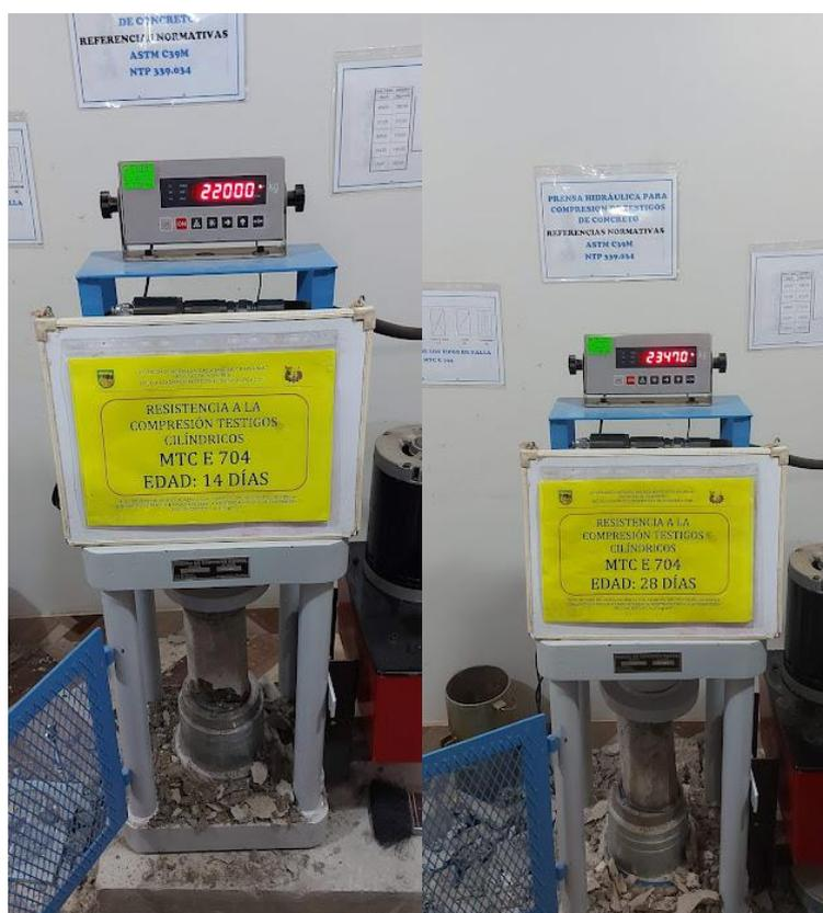
Figura 66 — Ensayo a la compresión simple del concreto a edades de 14 y 28 días
