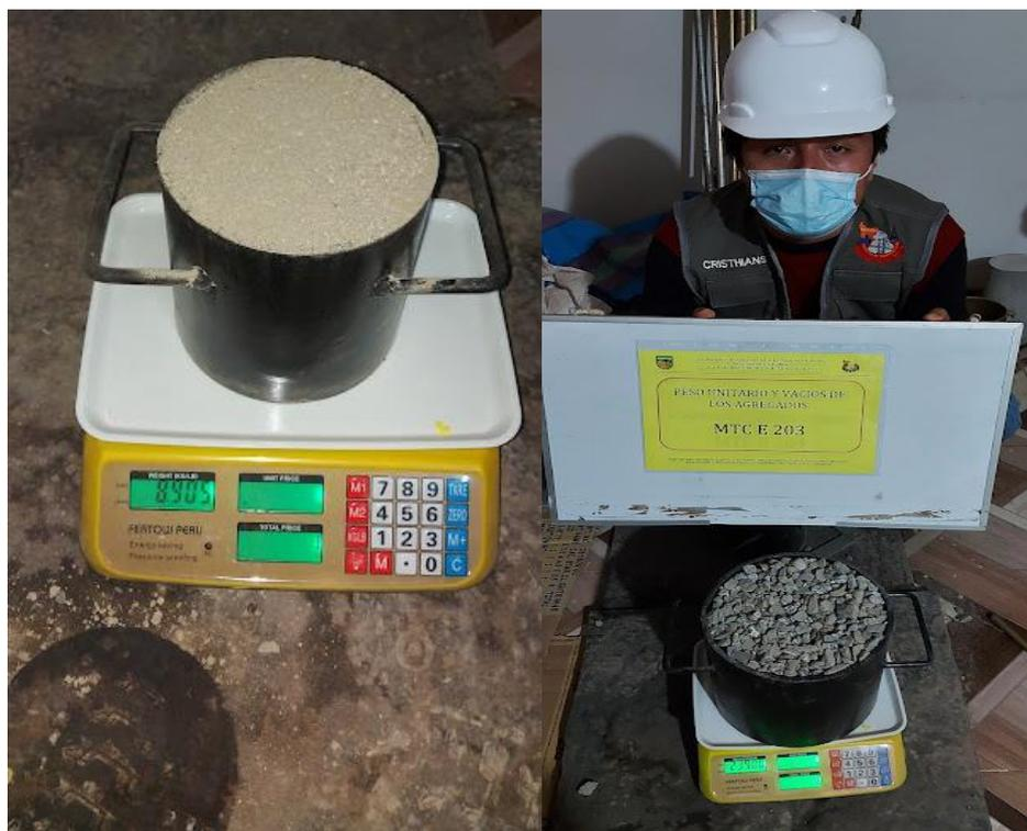
Figura 54 — Peso unitario del agregado fino y agregado grueso
