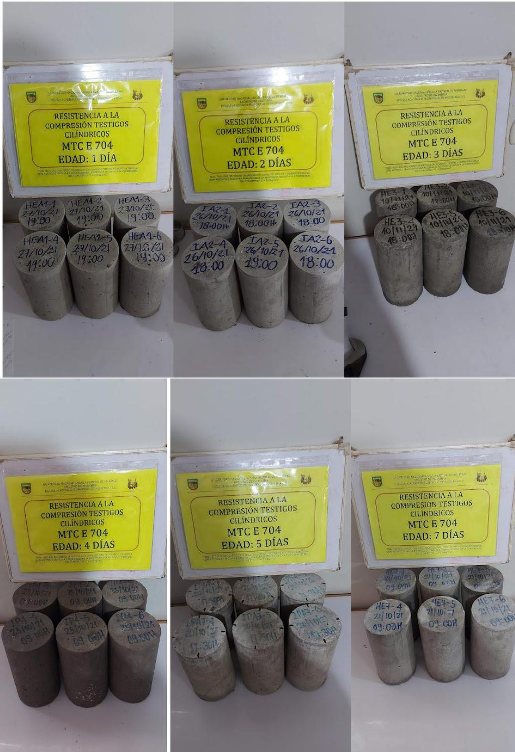
Figura 60 — Probetas de concreto antes del ensayo a la compresión simple
