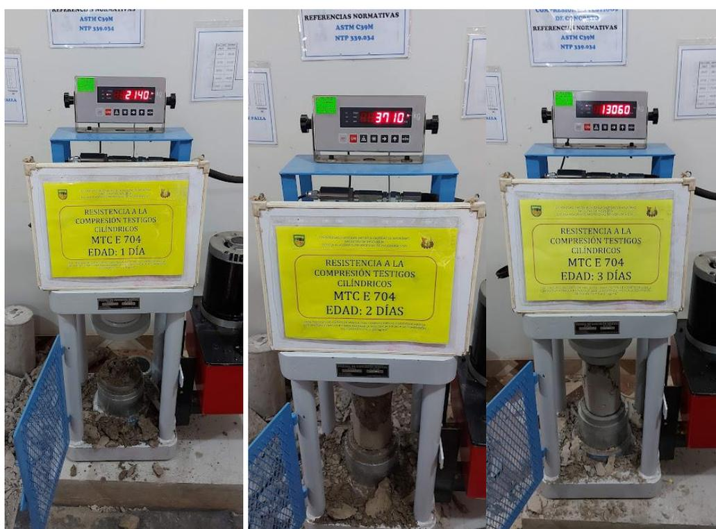
Figura 64 — Ensayo a la compresión simple del concreto a edades de 1, 2 y 3 días
