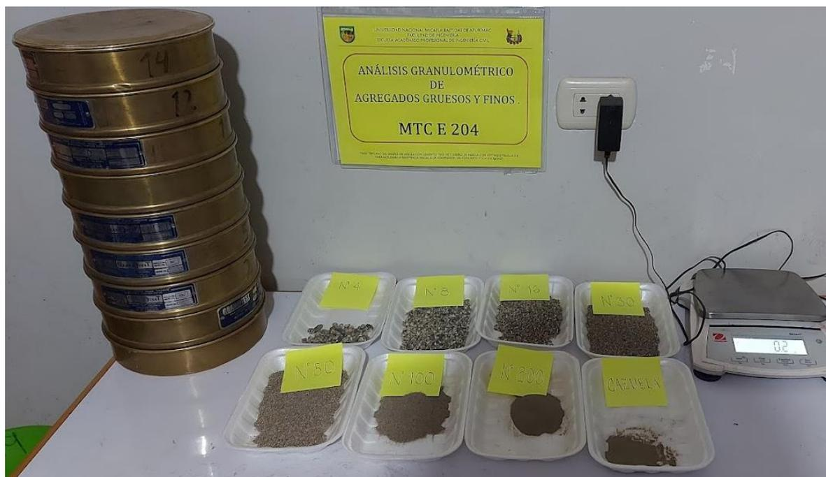
Figura 52 — Análisis granulométrico del agregado grueso
