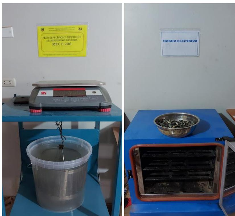
Figura 55 — Peso específico y absorción del agregado grueso
