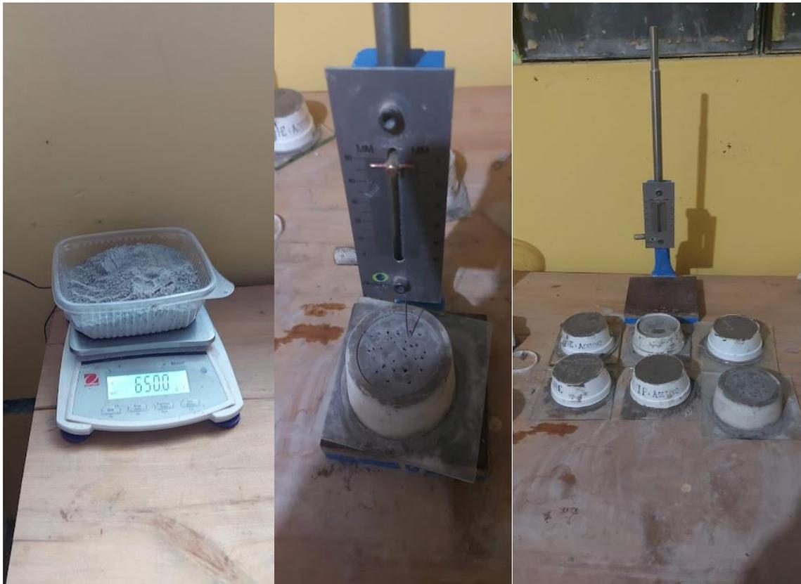
Figura 67 — Ensayo del tiempo de fraguado del cemento
