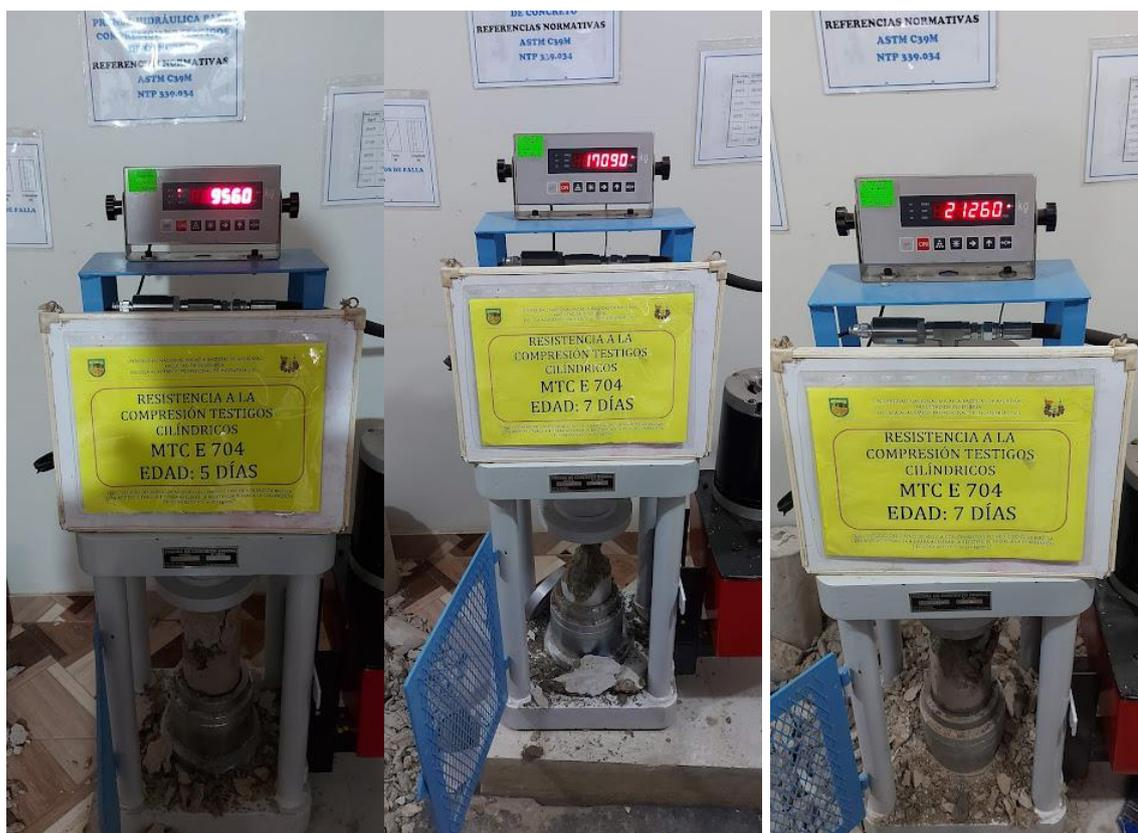
Figura 65 — Ensayo a la compresión simple del concreto a edades de 4, 5, 7 días
