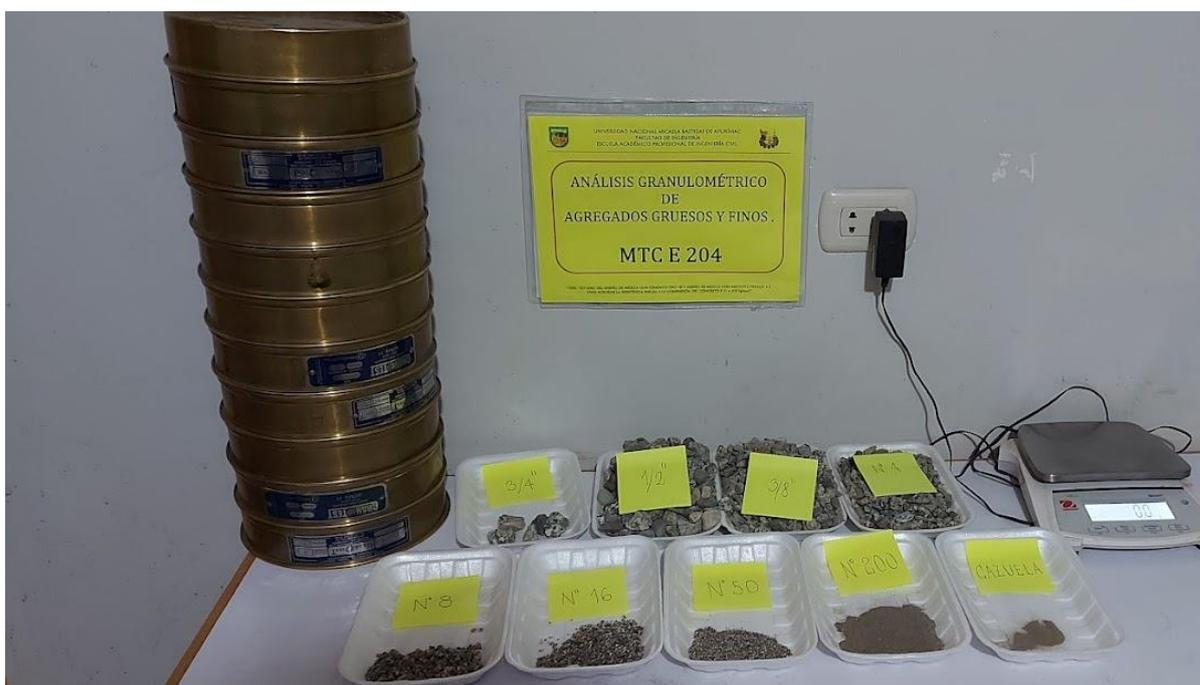
Figura 53 — Análisis granulométrico del agregado fino
