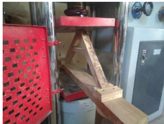
Figura 86 — Ensayo de compresión en tijerales
