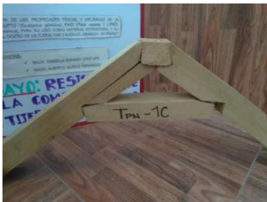
Figura 87 — Fallas del ensayo de compresión en tijerales
