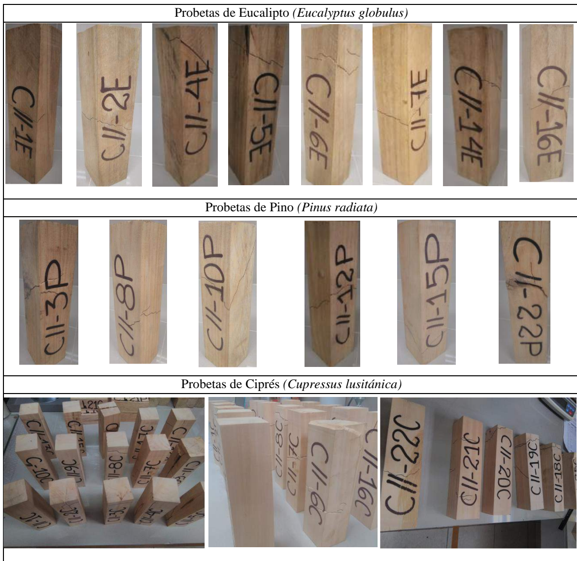
Figura 61 — Fallas de las probetas por compresión axial o paralela al grano
