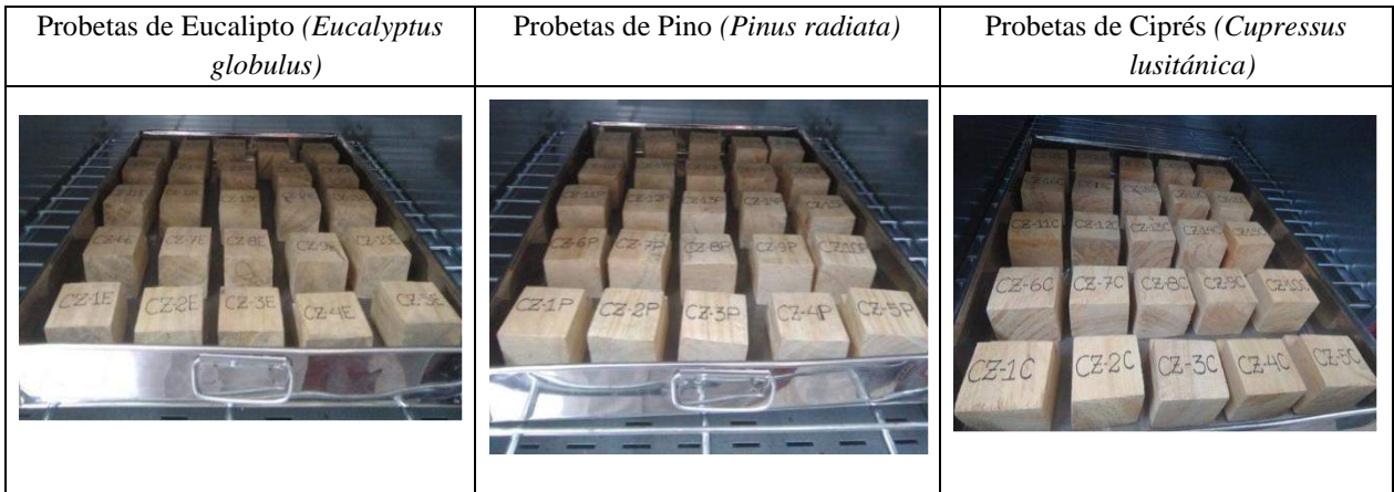
Figura 68 — Secado de las probetas en un horno a una temperatura de 103°C ± 2°C
