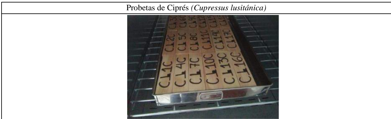
Figura 63 — Secado de las probetas en un horno a una temperatura de 103^{\circ}\text{C} \pm 2^{\circ}\text{C}
