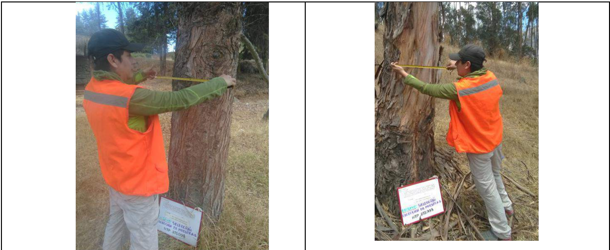
Figura 88 — Verificación del asesor del diámetro mayor a 30cm aplicando la NTP 251.008
