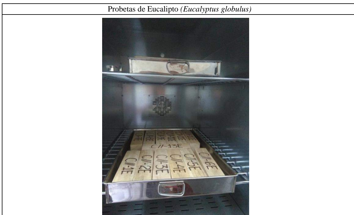
Figura 57 — Secado de las probetas en un horno a una temperatura de 103^{\circ}\text{C} \pm 2^{\circ}\text{C}
