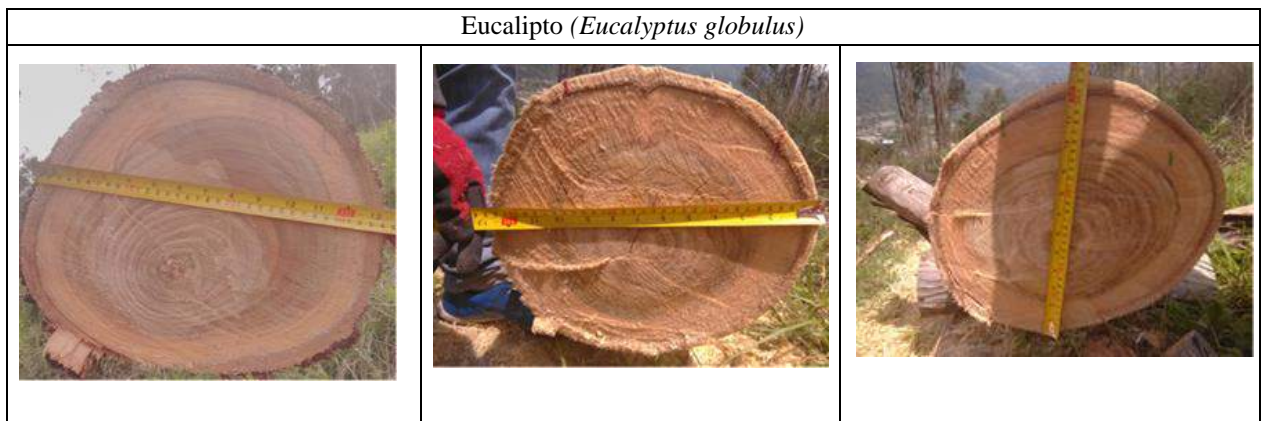
Figura 51 — Selección de viguetas dentro de las trozas para la extracción de probetas
