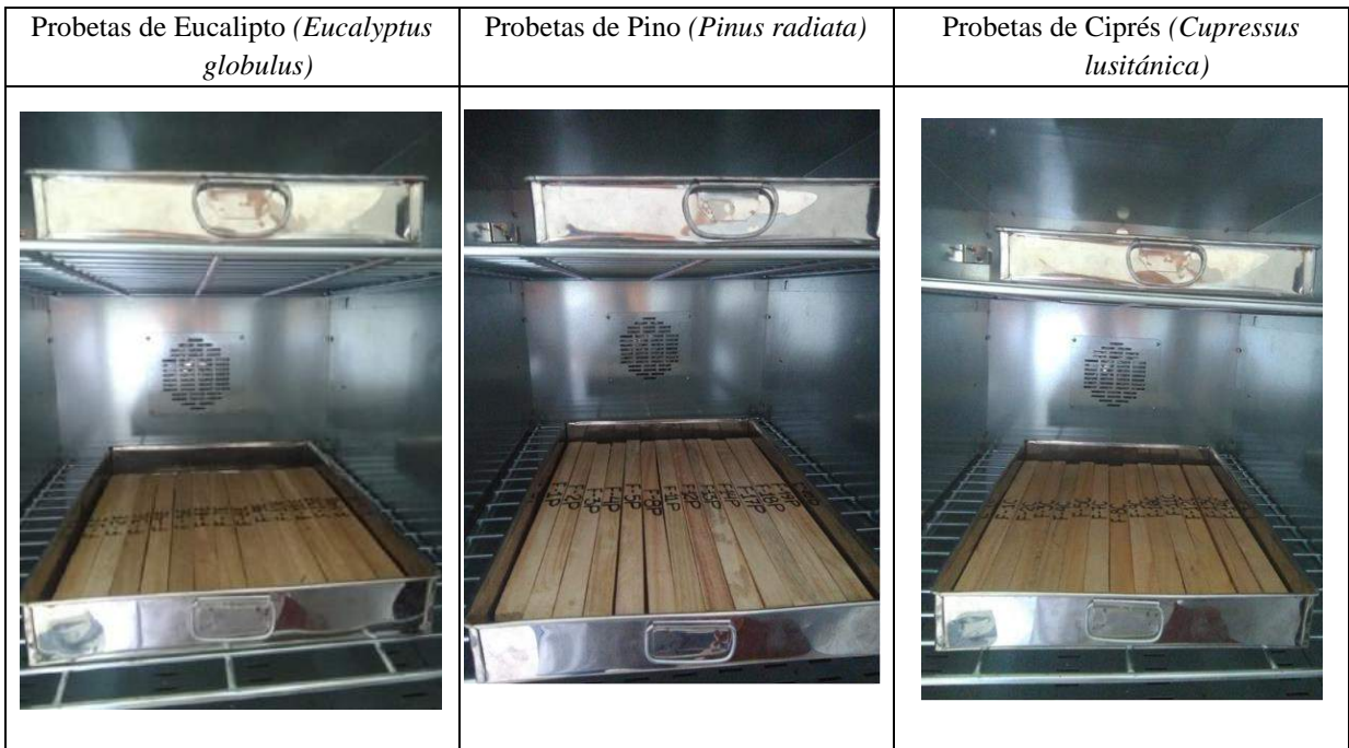
Figura 74 — Secado de las probetas en un horno a una temperatura de 103^{\circ}\text{C} \pm 2^{\circ}\text{C}
