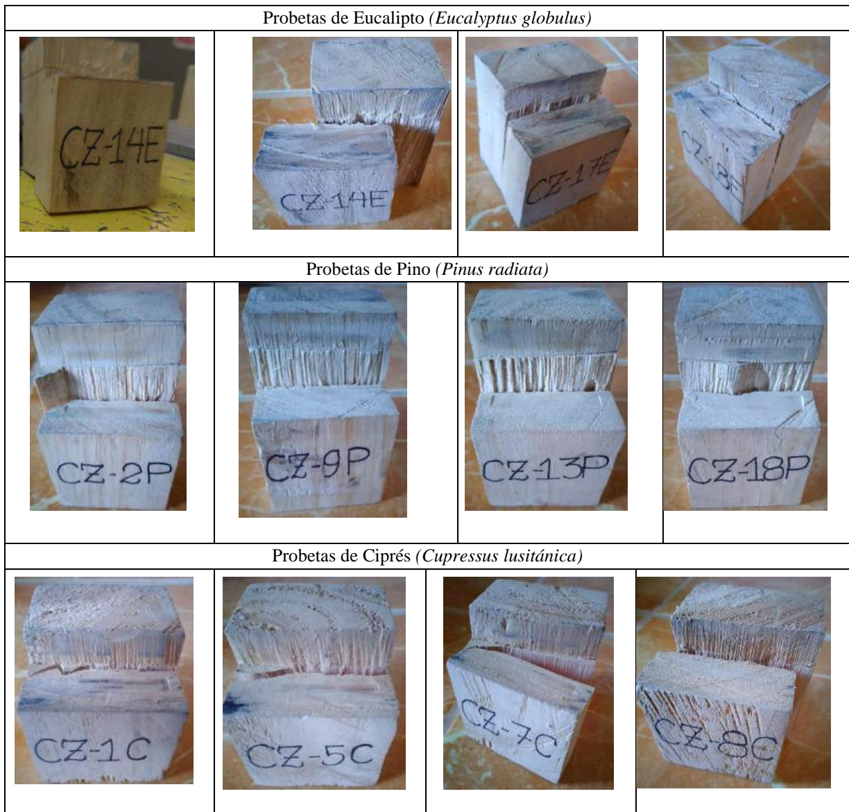
Figura 72 — Fallas de las probetas de cizallamiento paralelo al grano
