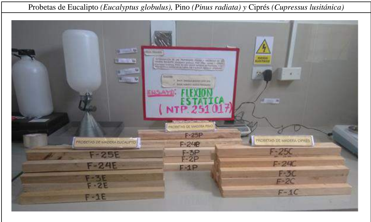
Figura 73 — Probetas para el ensayo de flexión estática
