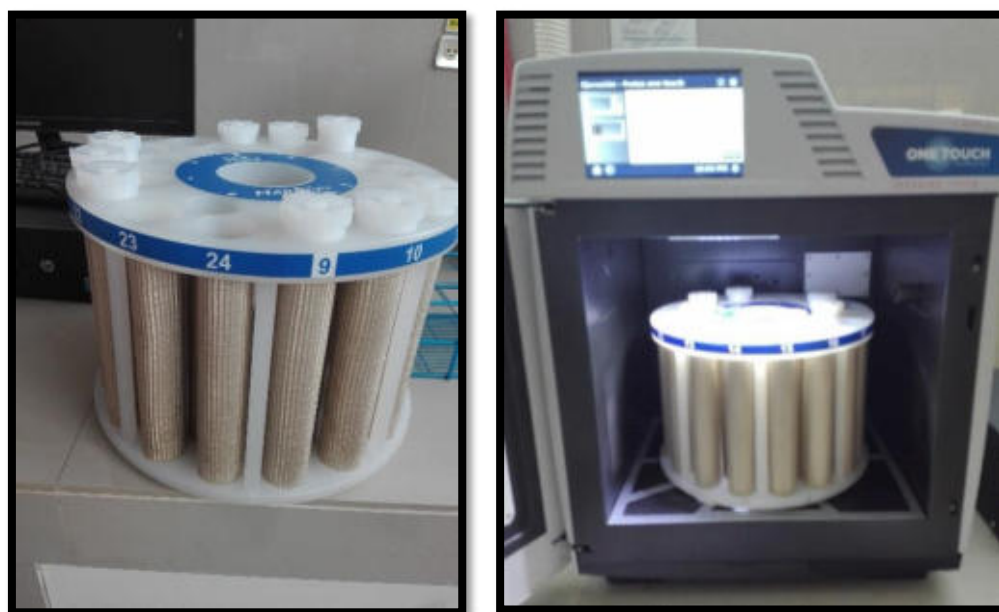
Figura 75 — Carrusel cargado con muestra / Digestor Microondas digestando muestra de granos andinos
