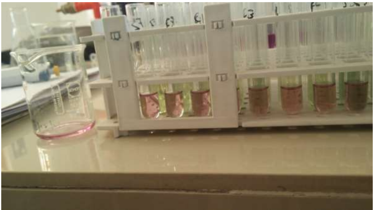
Figura 25 — Análisis de las muestras para determinar capacidad antioxidante (DPPH)
