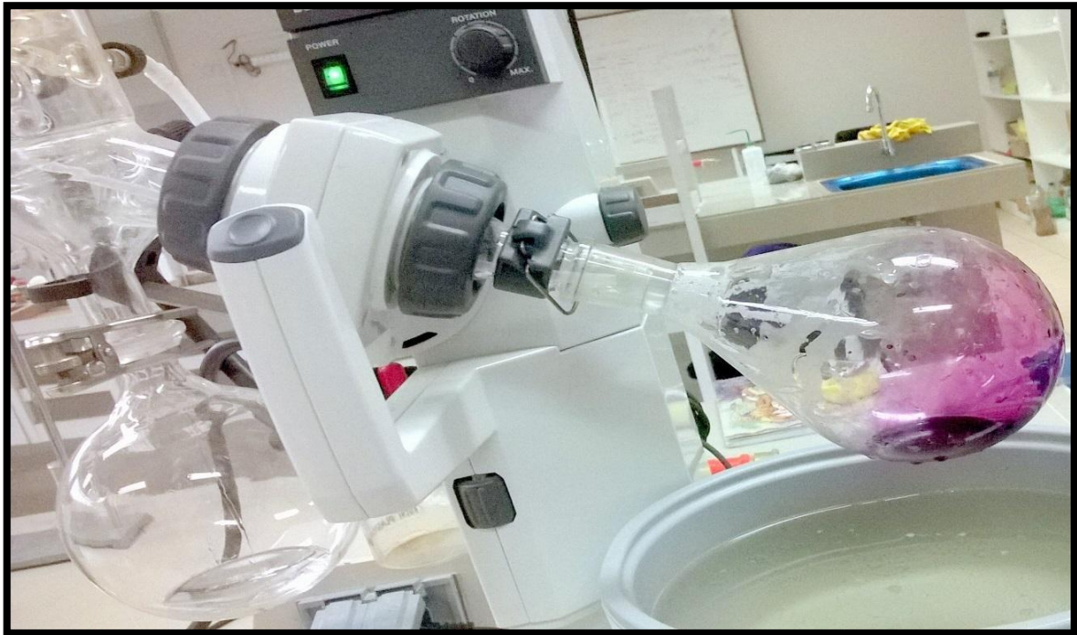
Figura 39 — Rotavapor: Reducción de solventes a presión reducida de extractos de papas nativas pigmentadas
