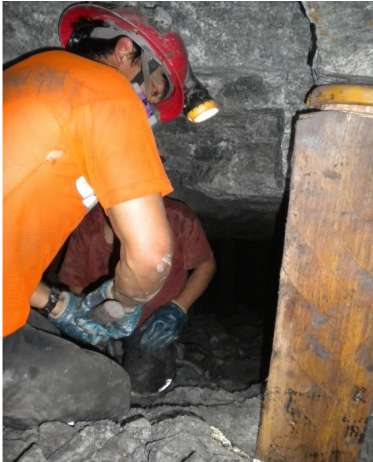
Figura 9 — Instalación de “Jackpot” y puntal de madera
