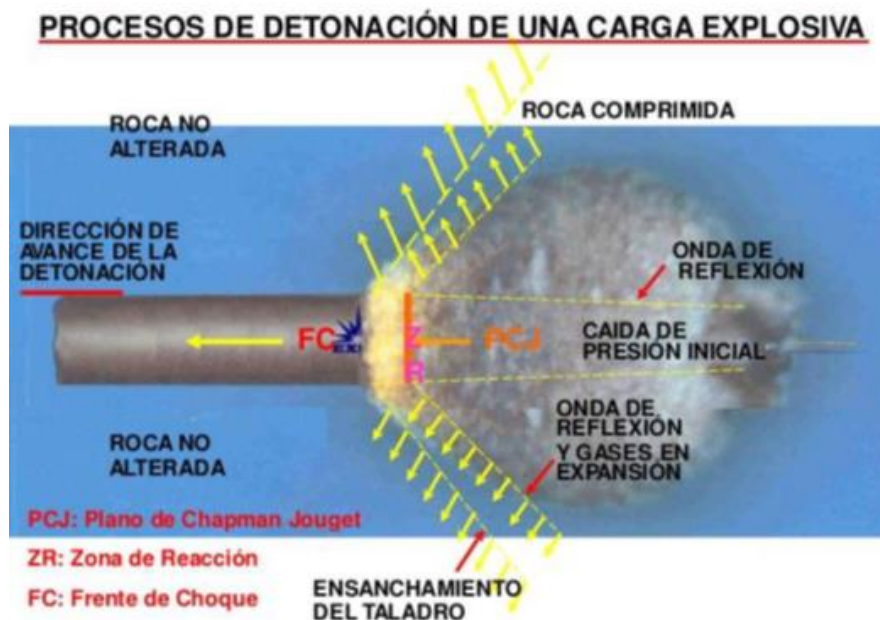
Figura 7 — proceso de detonación de una carga explosiva Extraído de tesis CHURA (2019)
