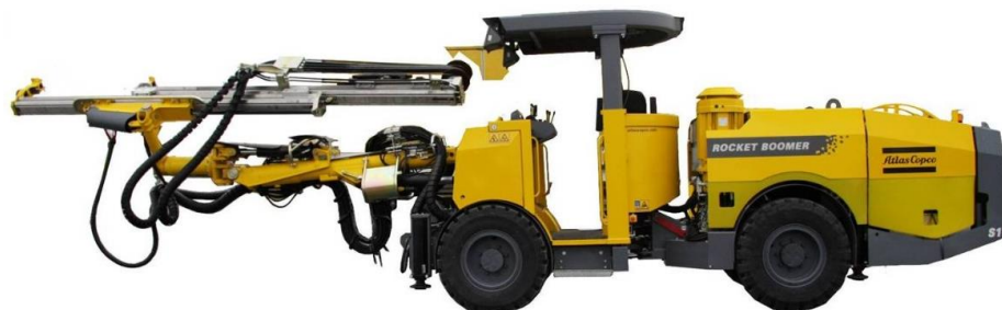
Figura 5 — equipo de perforación frontal (Jumbo) Rocket Boomer S1D, utilizada en MARSÁ.
