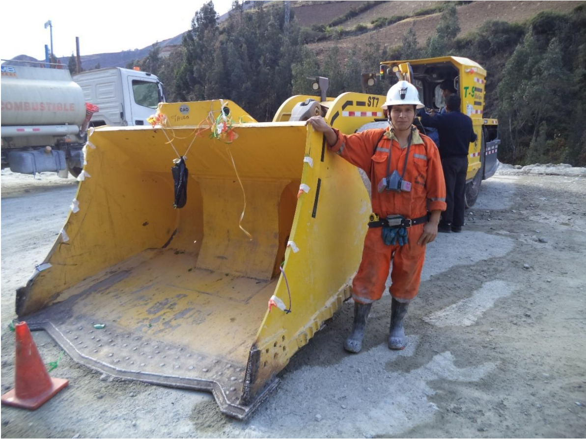
Figura 38 — Scoop utilizado para la limpieza en la profundización de la rampa Patrick IV
