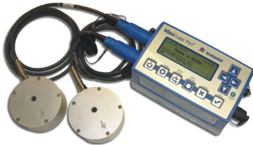
Figura 13 — Sismógrafo y geófono INSTANTEL MINIPRO6 utilizado en las mediciones de las vibraciones
