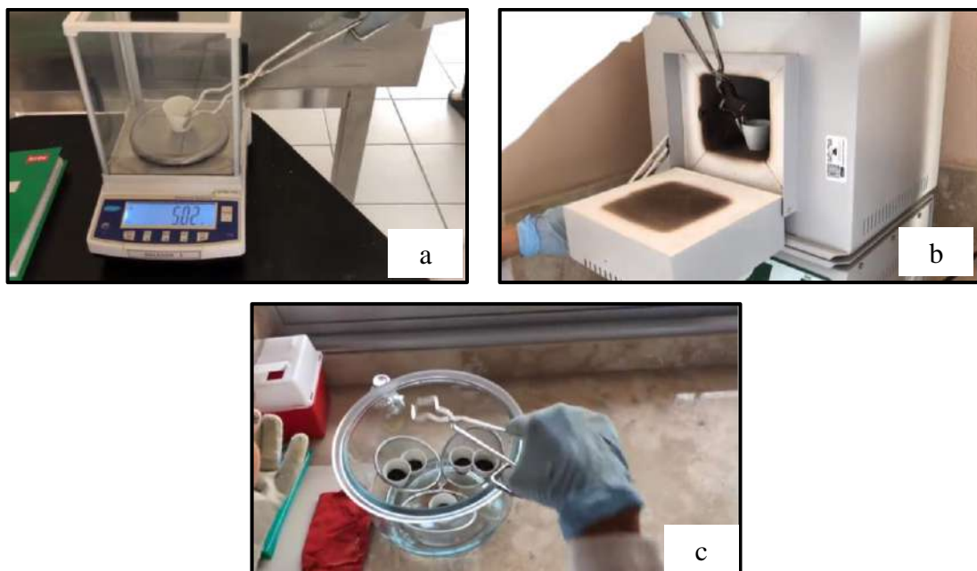
Figura 18 — Fotografías de cenizas (a) 5g de hidromiel, (b) incineración a 550°C (c) enfriamiento a peso constante
