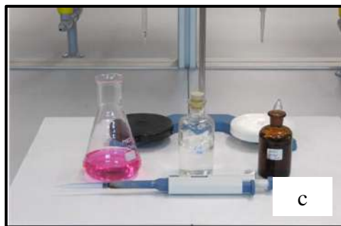
Figura 17 — Fotografías de acidez volátil (a) destilación del hidromiel (b) 5 gotas de fenolftaleína (c) volumen gastado de NaOH (0.02 M).
