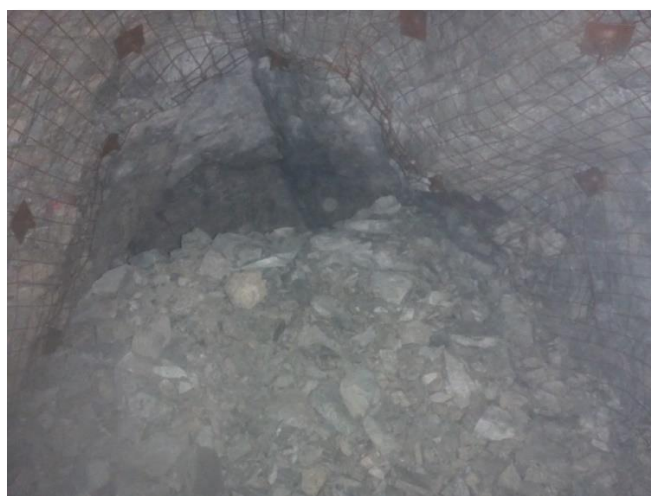
Figura 31 — Material fragmentado después del disparo (XC 10654-N
