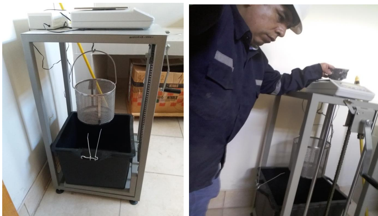
Figura 20 — Principio de Arquímedes para el cálculo de la densidad de Halita
