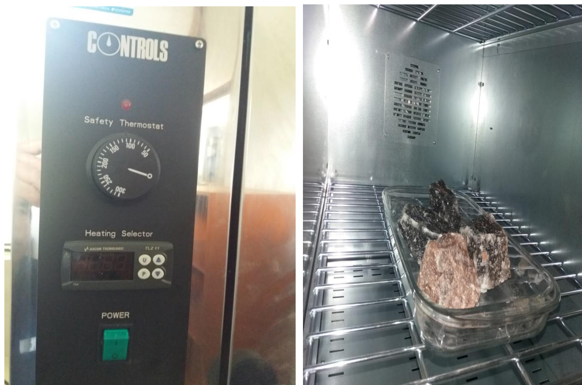
Figura 19 — Estufa de secado de muestras de Halita
