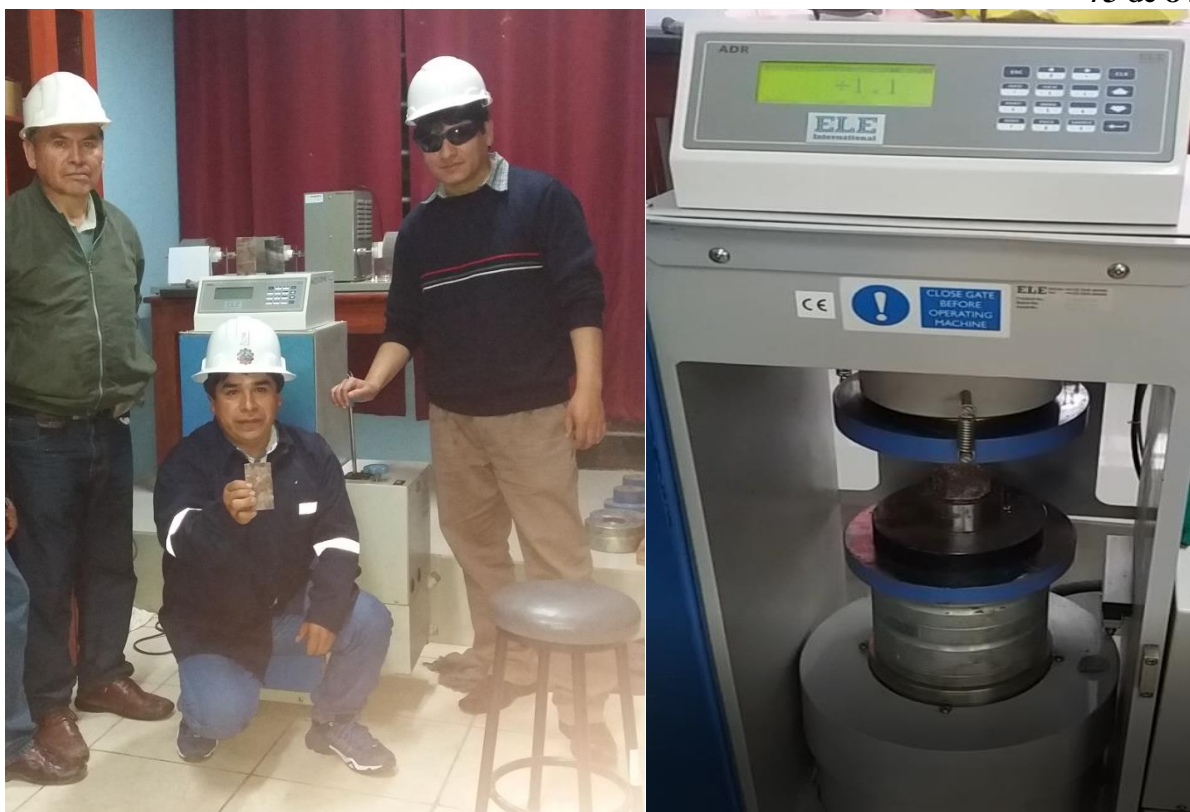
Figura 25 — Equipo semi automático digital para el ensayo de compresión uniaxial
