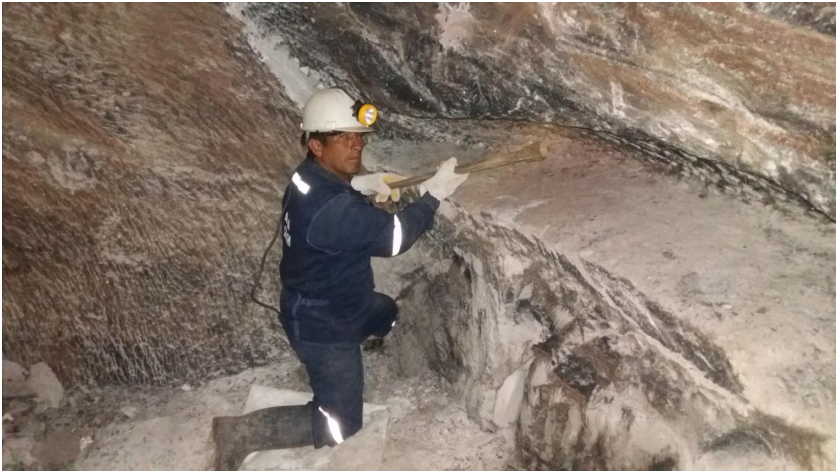
Figura 31 — Piqueo manual en los frentes de las cámaras y pilares
