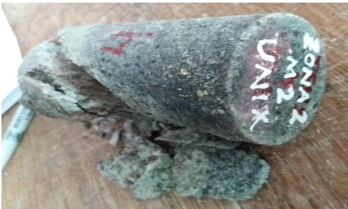
Figura 26 — Probeta después del ensayo a la resistencia de compresión uniaxial
