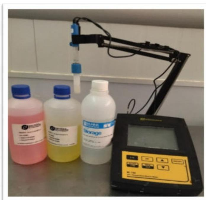
**Figura 15— Potenciómetro**
