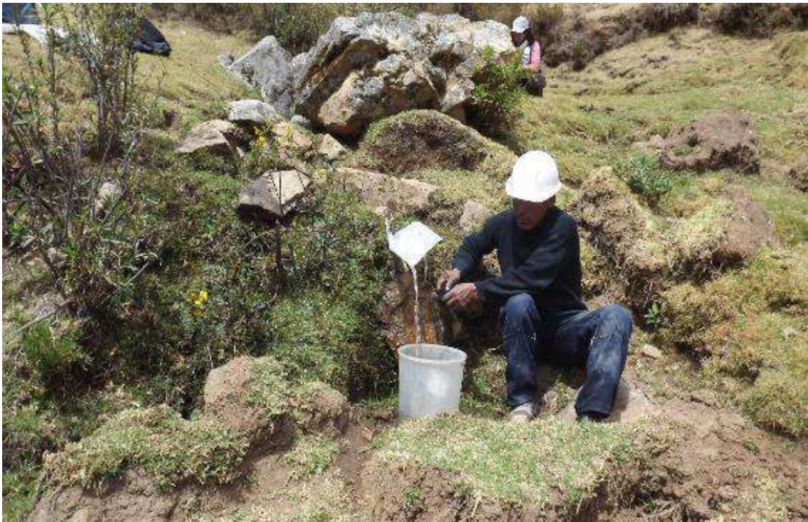
Figura 51 — Medición de Caudal por método volumétrico, sector Accoñoso
