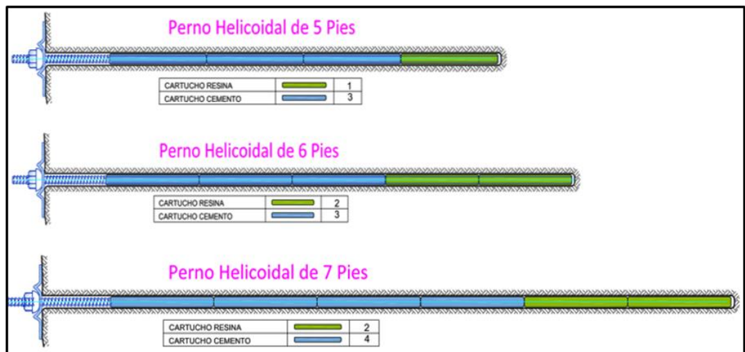
Figura 8 — Instalación de pernos helicoidales de 5,6 y 7 pies
