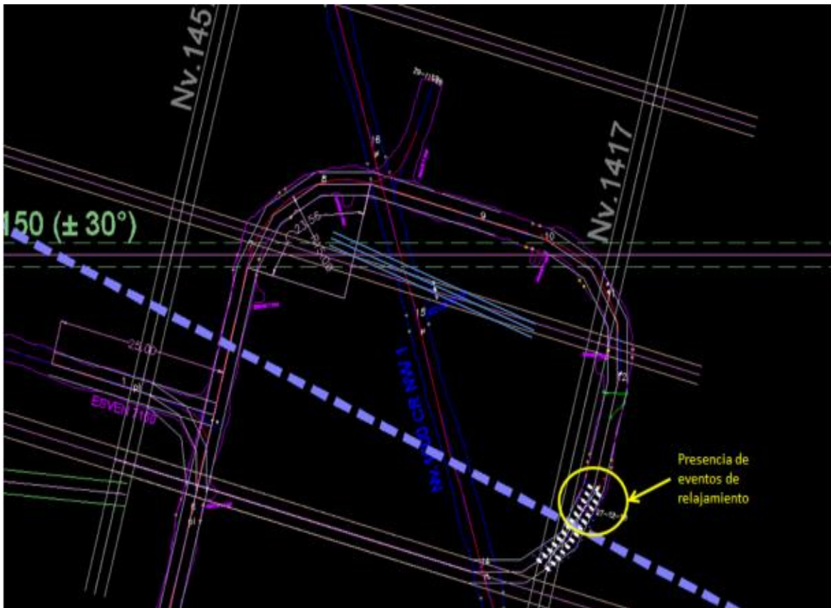
Figura 47 — Plano geomecánico NV 1467 RP 7040, zona del evento de relajamiento de rocas
