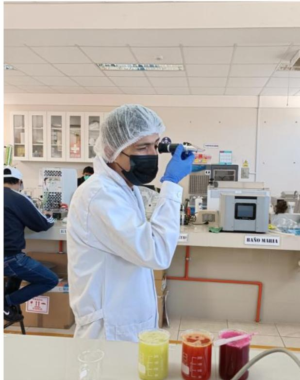
**Figura 16** — Determinación de sólidos solubles (°Brix) con refractómetro
