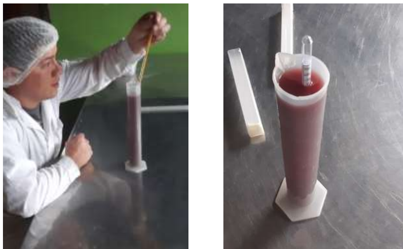
Figura 22 — Medición de la Temperatura y densidad del mosto
