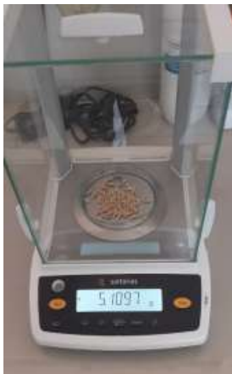
Figura 15 — Pesado de muestra para determinación de humedad
