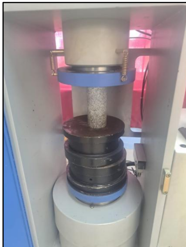
Figura 16 — Realización de ensayo de compresión uniaxial
