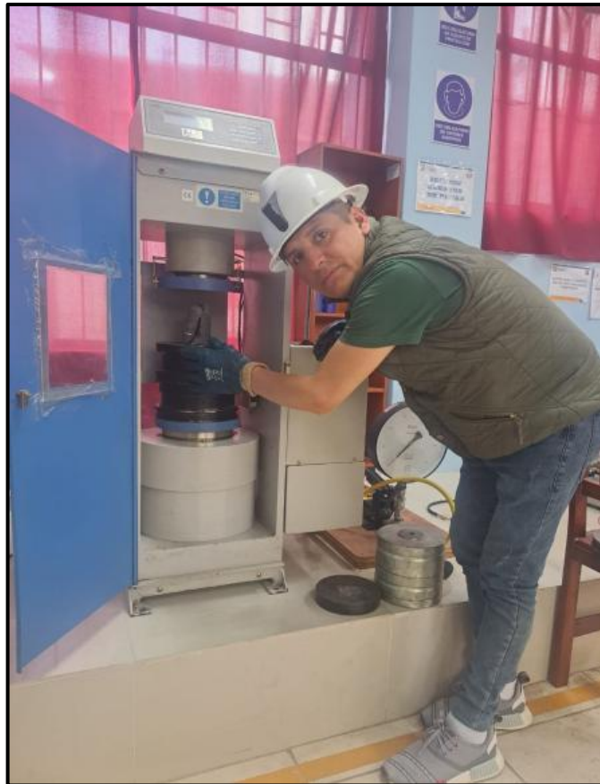
Figura 13 — Realización de ensayo de ensayo de compresión uniaxial en el laboratorio de mecánica de rocas de la escuela de ingeniería de minas – Unamba
