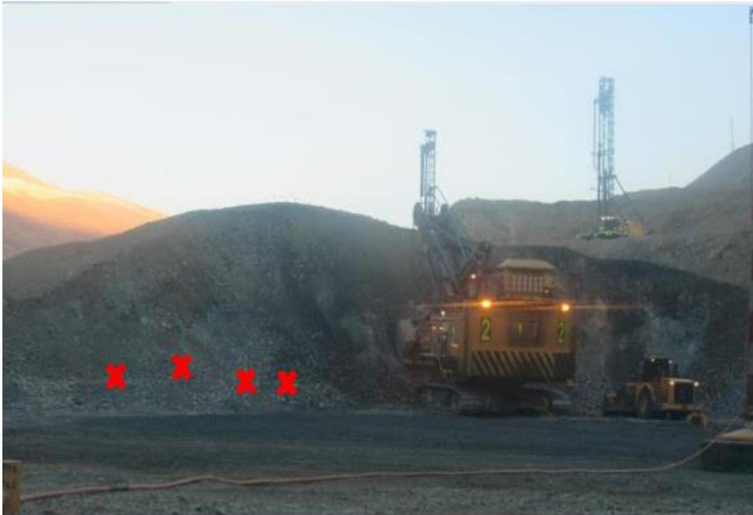
**Figura 57 — Pala eléctrica realizando carguío en proyecto 3765 – 011 Jahuapaylla Baja**
