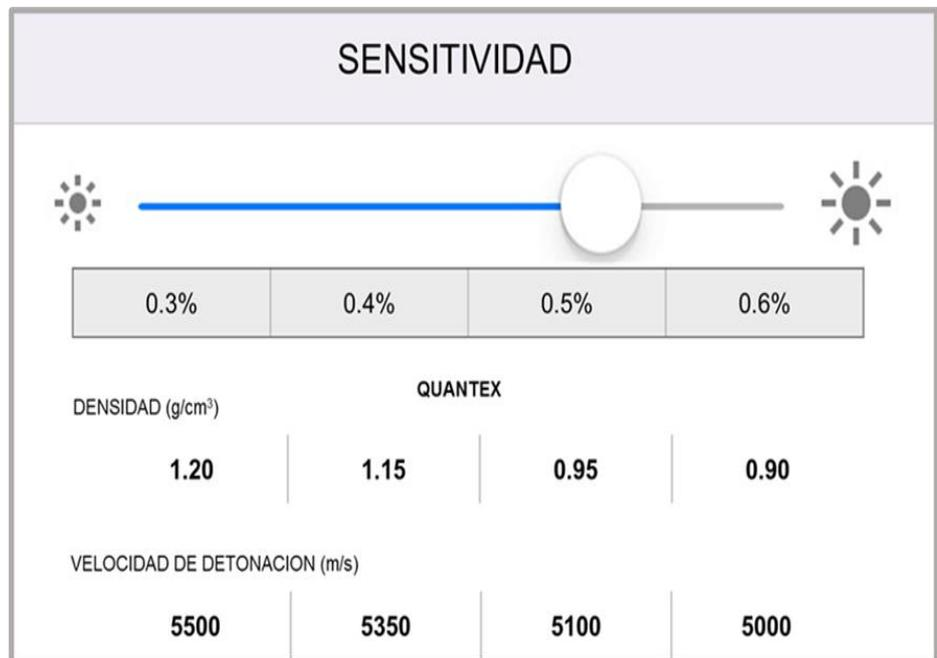
**Figura 16 — Rango de densidades de carguío de la mezcla explosiva**
