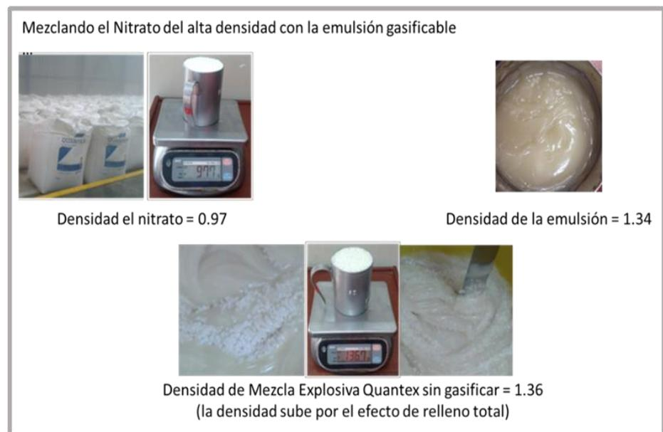
**Figura 13 — Obtención de la mezcla explosiva sin nitrito de sodio**
