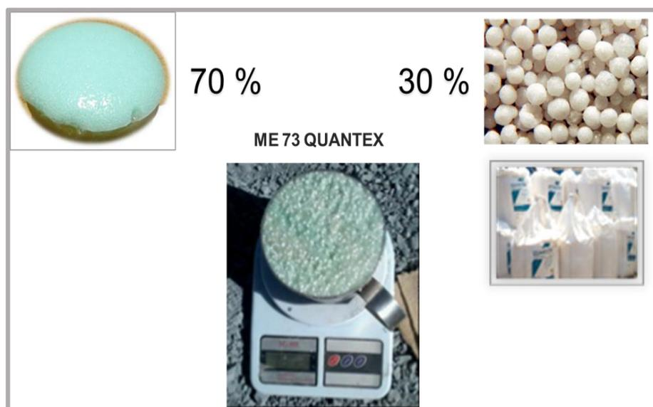
**Figura 10 — Mezcla Explosiva Quantex (MEQ)**
