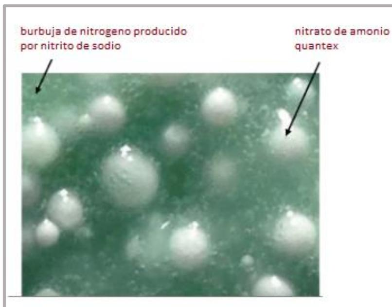
**Figura 12 — Nitrito de sodio en la mezcla explosiva Quantex**
