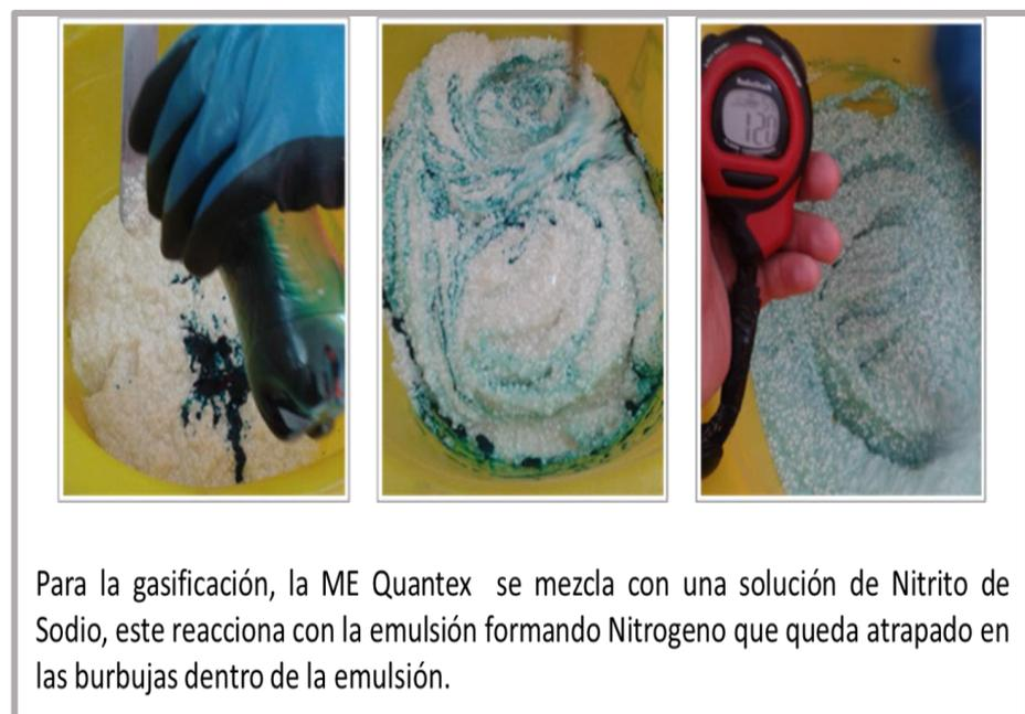
**Figura 14 — Reacción de la mezcla explosiva con nitrito**
