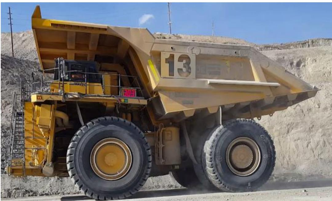
**Figura 56 — Camión Komatsu 930E**
