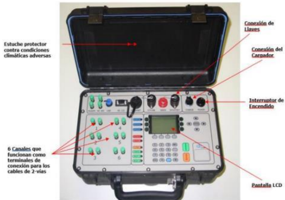
Figura 13 — Bench Box/Estación Base DigiShot Plus Externamente
