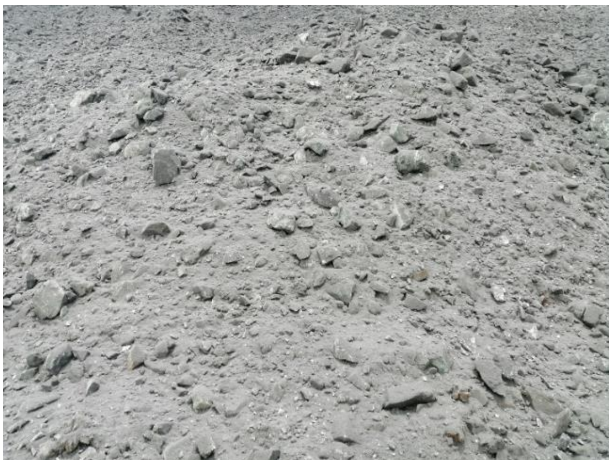
Figura 40 — Resultados del material fragmentado con detonadores electrónicos (post voladura)
