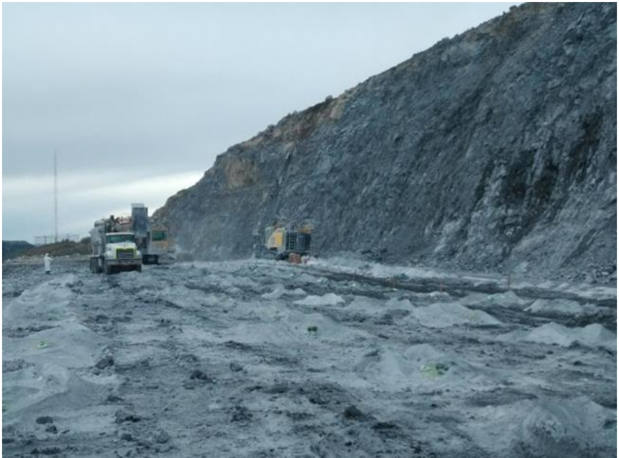
Figura 31 — Zona cargada con detonador Digishot Plus (Cerro Candela)
