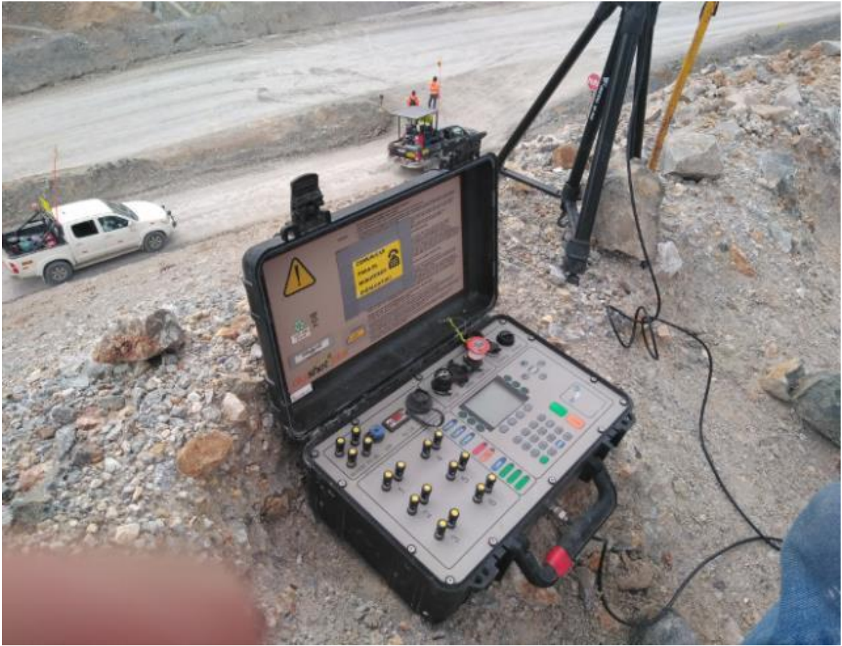
Figura 33 — Bench station colocado en el punto de disparo de voladura
