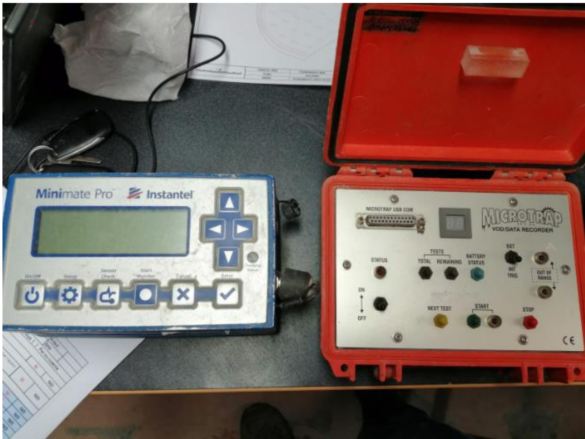
Figura 35 — Equipos de control de vibraciones pasando pruebas y check list
