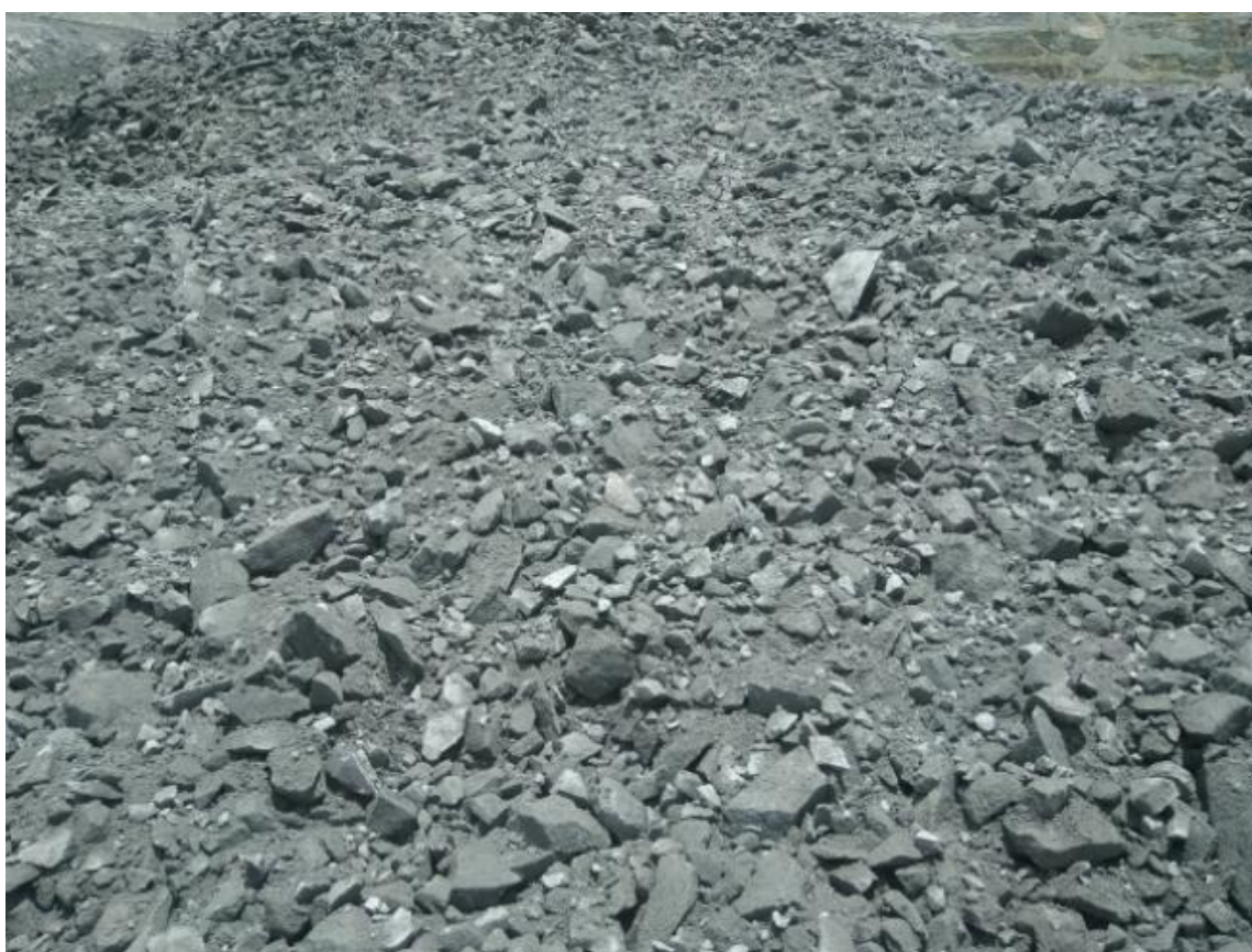
Figura 39 — Resultados del material fragmentado con detonadores electrónicos (post voladura)
