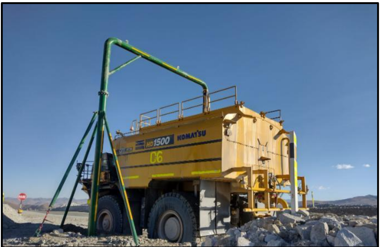
Figura 30—Abastecimiento de agua al camión cisterna Komatsu HD1500-8
