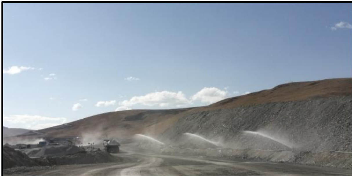
Figura 25— Sistema de aspersión en funcionamiento tramo 09
