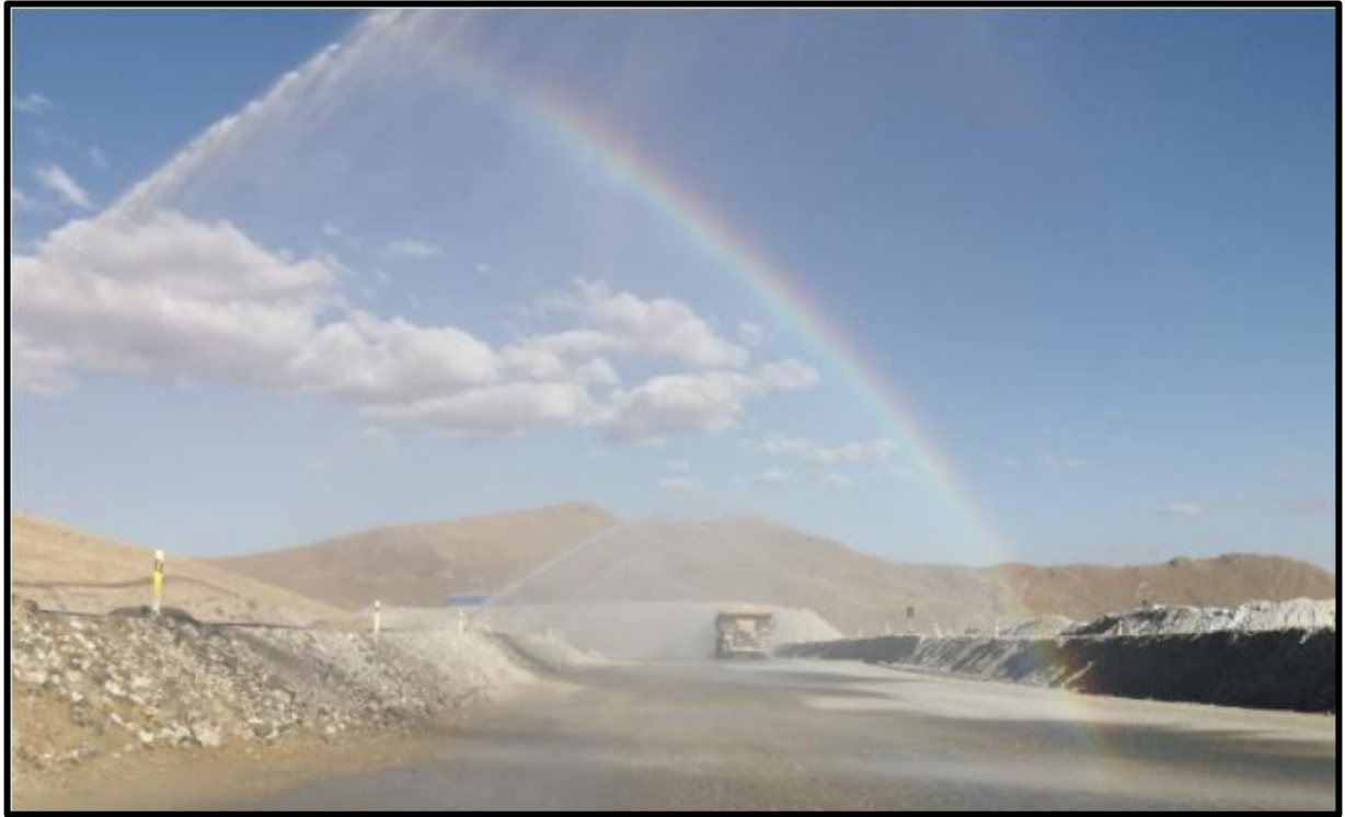
Figura 27—Encendido de los aspersores N° 4 y 5 en el tramo 09
