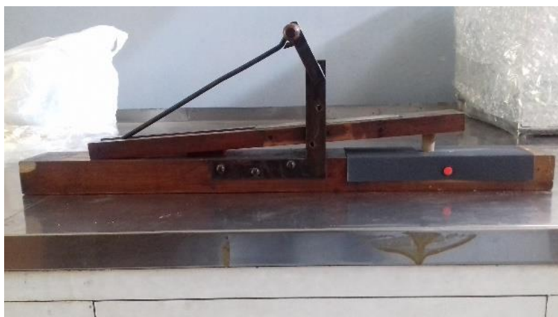
Figura 31 — Prueba de la resistencia al frote en seco
