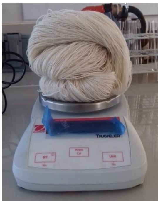
Figura 22 — Pesado de la fibra textil
