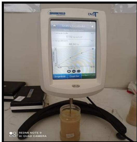
Figura 17 — Viscosidad de la muestra con 0.4 %
