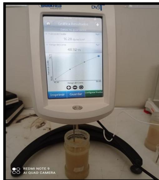
Figura 66 — Viscosidad de la muestra con formulacion 0.2 %
