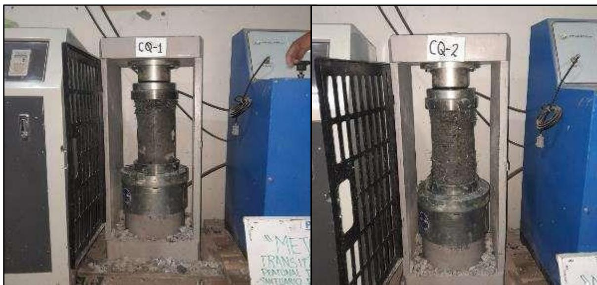
**Figura 26 — Resistencia en 7 días de roturas a compresión axial del concreto con 3% de plastómeros**
