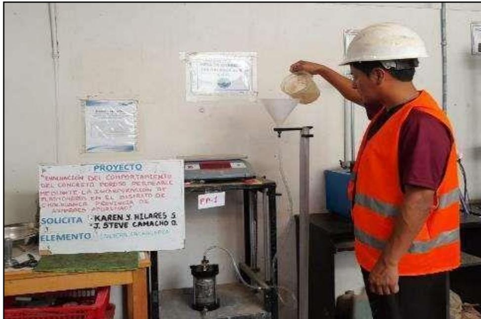
**Figura 49 — Ensayo de permeabilidad del concreto patrón (ACI 522 R - 10)**
