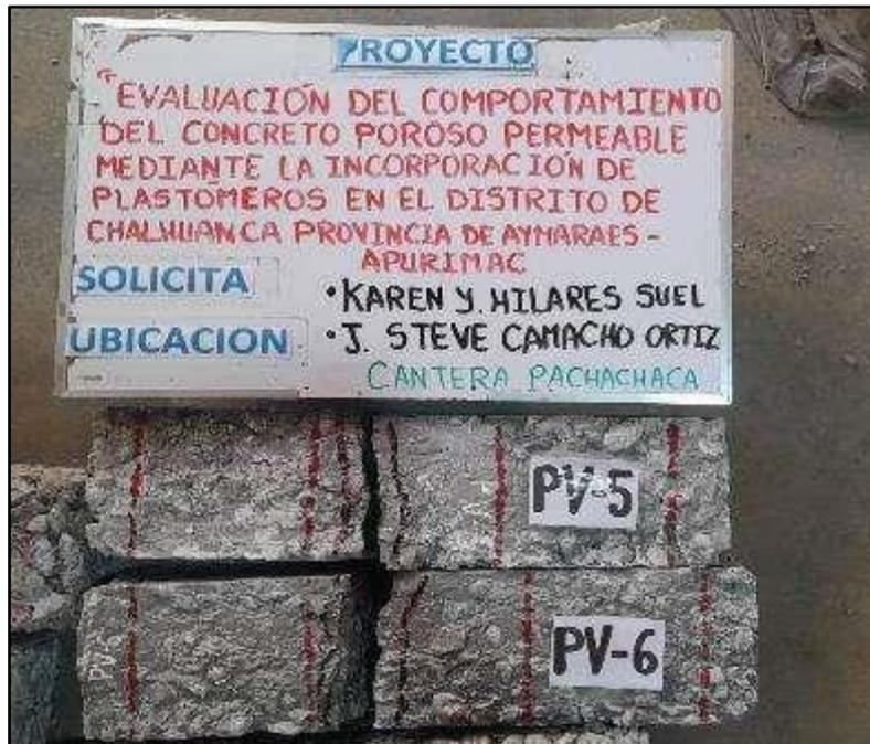
Figura 45 — Resistencia a la flexión en 28 días de vigas con cargas a los tercios del tramo, del concreto patrón
