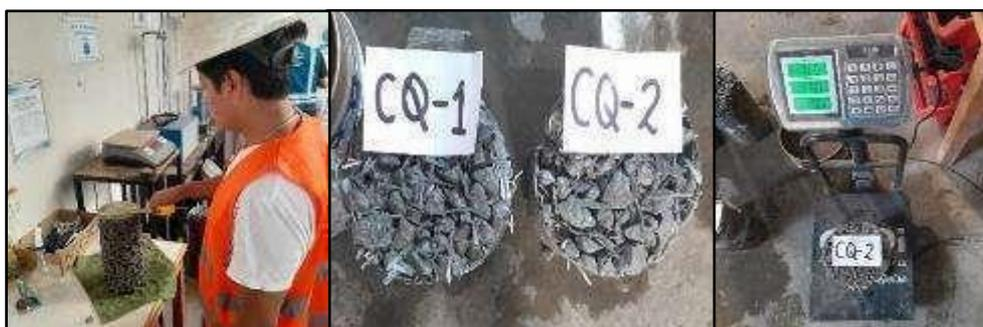
**Figura 11 — Medición y peso de los especímenes antes de la compresión**
