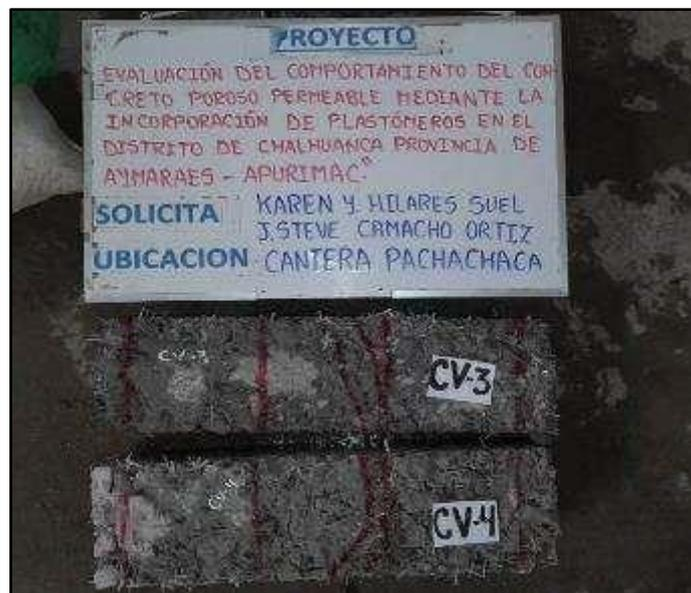
**Figura 44 — Resistencia a la flexión en 14 días de vigas con cargas a los tercios del tramo, del concreto con 3% de plastómeros**
