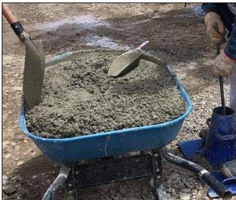
**Figura 20 — Medición de asentamiento**
