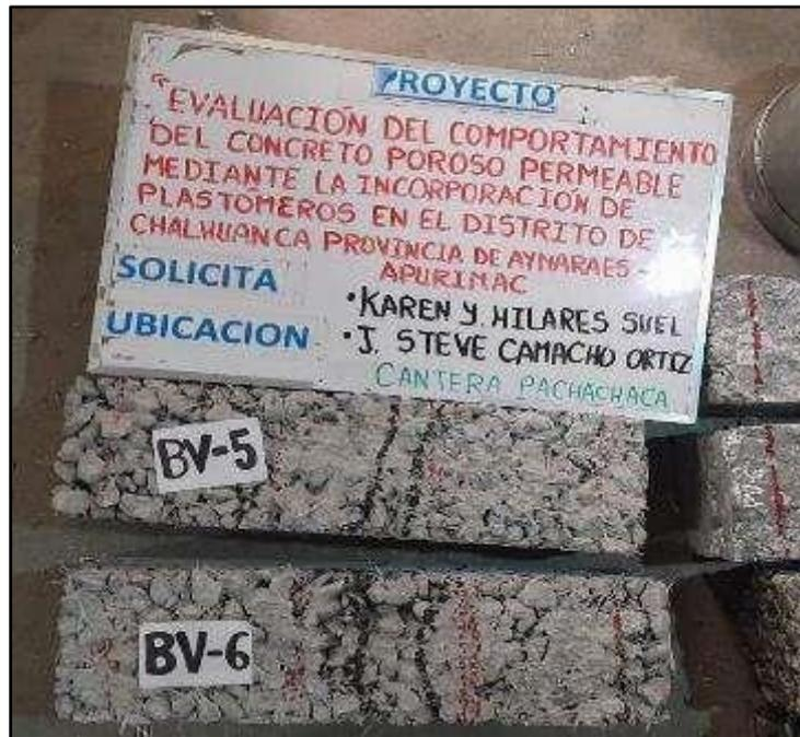
Figura 47 — Resistencia a la flexión en 28 días de vigas con cargas a los tercios del tramo, del concreto con 1.5% de plastómeros
