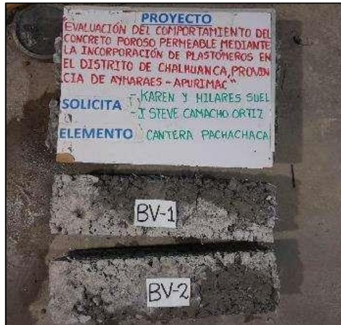
Figura 39 — Resistencia a la flexión en 7 días de vigas con cargas a los tercios del tramo, del concreto con 1.5% de plastómeros
