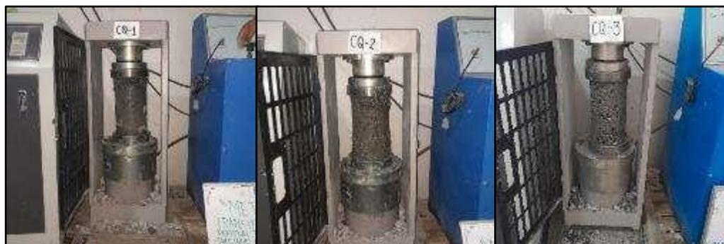
**Figura 12 — Prueba de resistencia a compresión de las briquetas**
