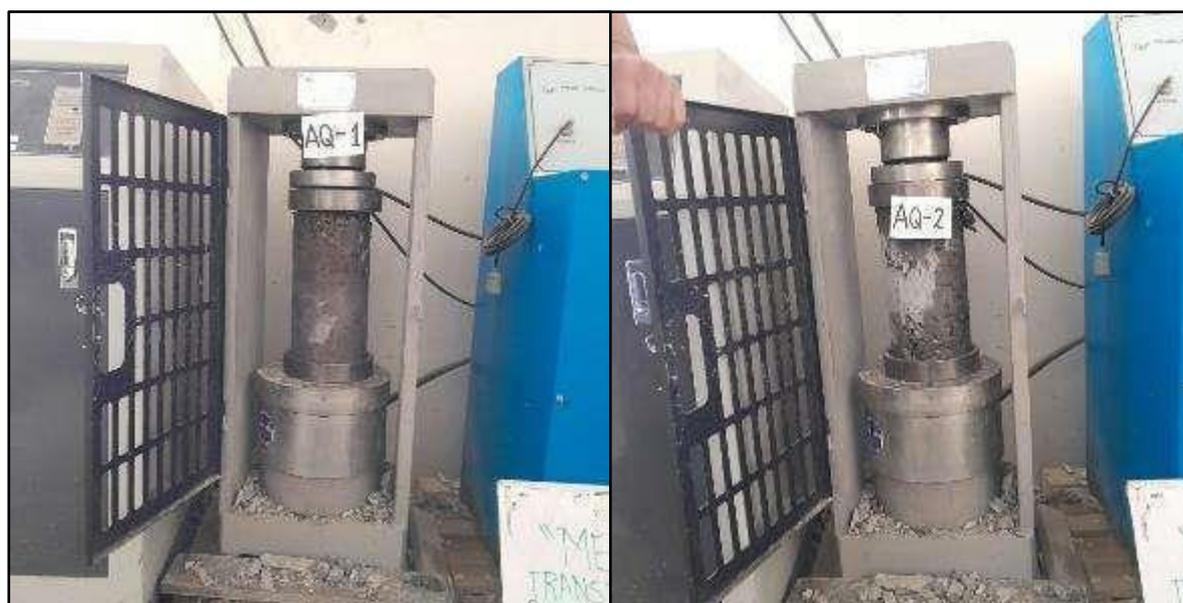
Figura 24 — Resistencia en 7 días de roturas a compresión axial del concreto con 1% de plastómeros
