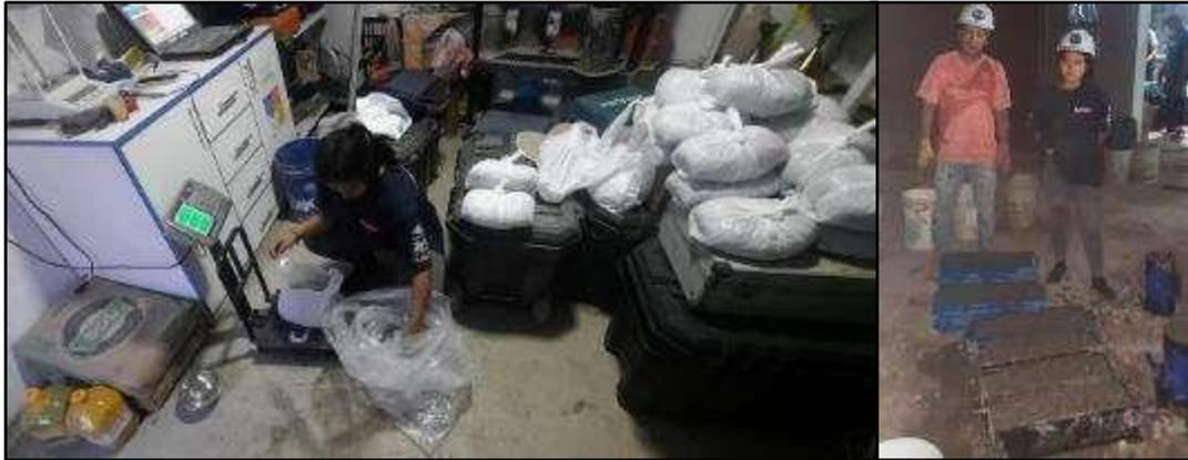
**Figura 7 — Pesaje de plastómeros para la adición al concreto permeable**
