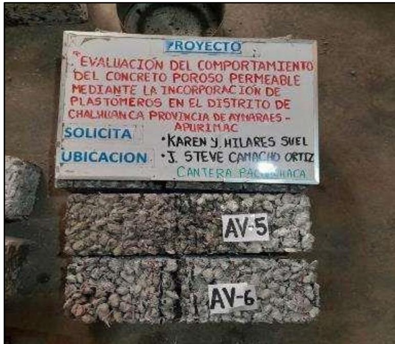
Figura 46 — Resistencia a la flexión en 28 días de vigas con cargas a los tercios del tramo, del concreto con 1% de plastómeros
