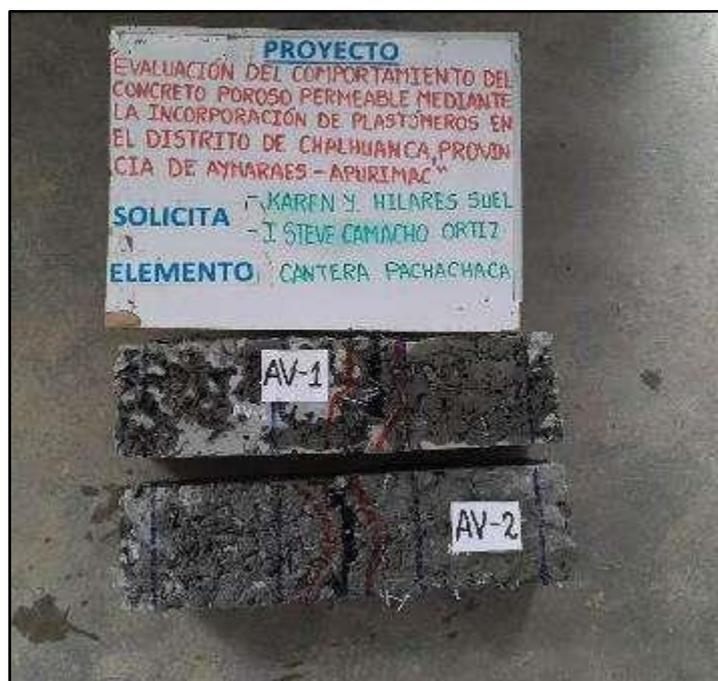
Figura 38 — Resistencia a la flexión en 7 días de vigas con cargas a los tercios del tramo, del concreto con 1% de plastómeros
