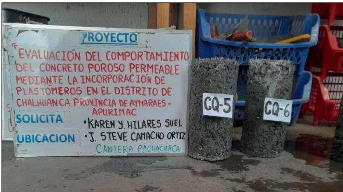
Figura 34 — Resistencia en 28 días de roturas a compresión axial del concreto con 3% de plastómeros
