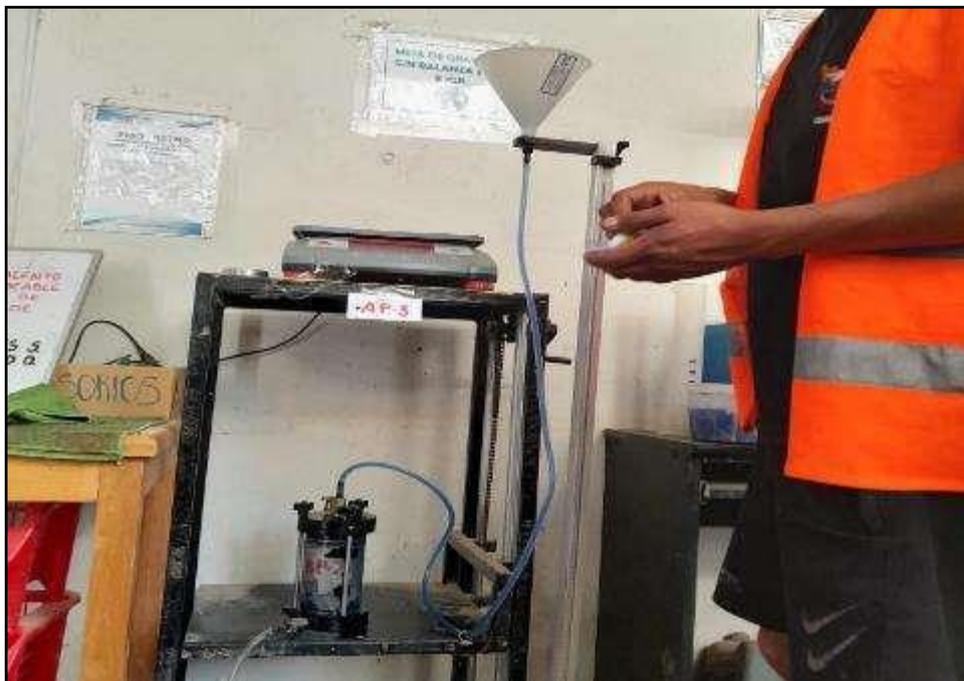
**Figura 50 — Ensayo de permeabilidad con concreto poroso +1% plastómeros**
