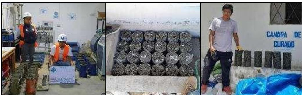
**Figura 9 — Desencofrado y curado de los especímenes a los 7, 14 y 28 días**
