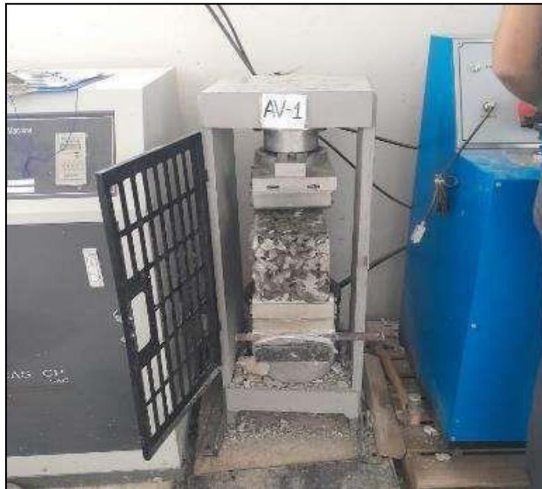
**Figura 36 — Resistencia a la flexión de vigas de concreto con cargas a los tercios del tramo en la máquina**
