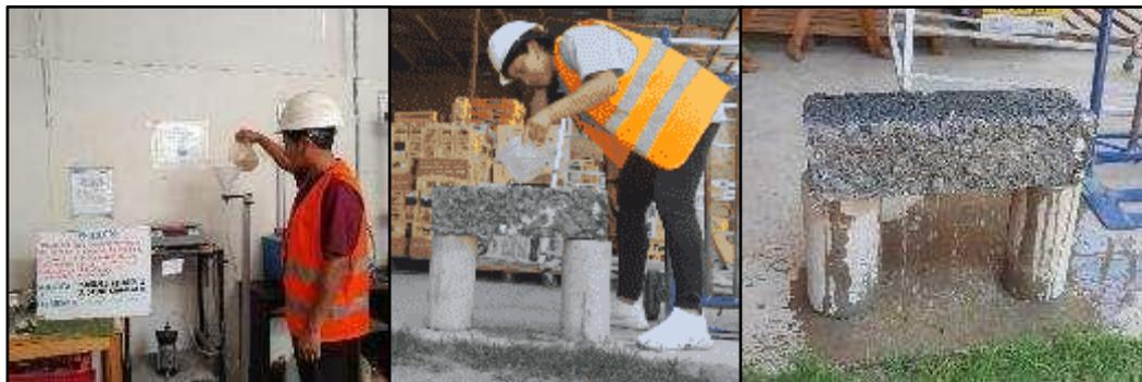
**Figura 14 — Prueba de permeabilidad del concreto poroso permeable**
