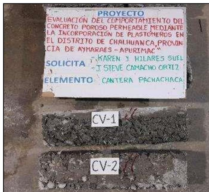
Figura 40 — Resistencia a la flexión en 7 días de vigas con cargas a los tercios del tramo, del concreto con 3% de plastómeros
