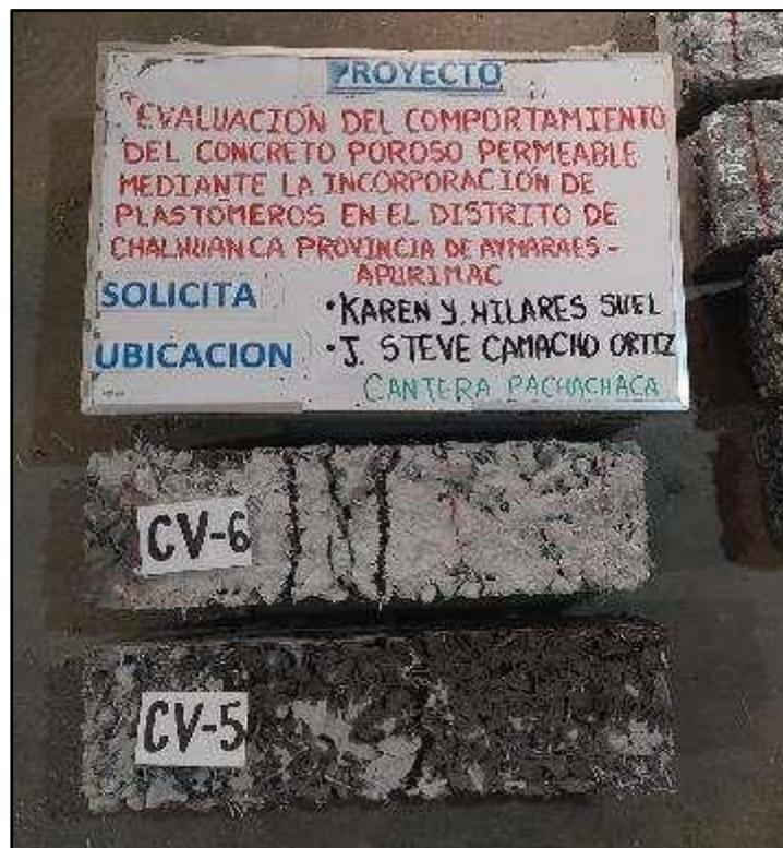
Figura 48 — Resistencia a la flexión en 28 días de vigas con cargas a los tercios del tramo, del concreto con 3% de plastómeros
