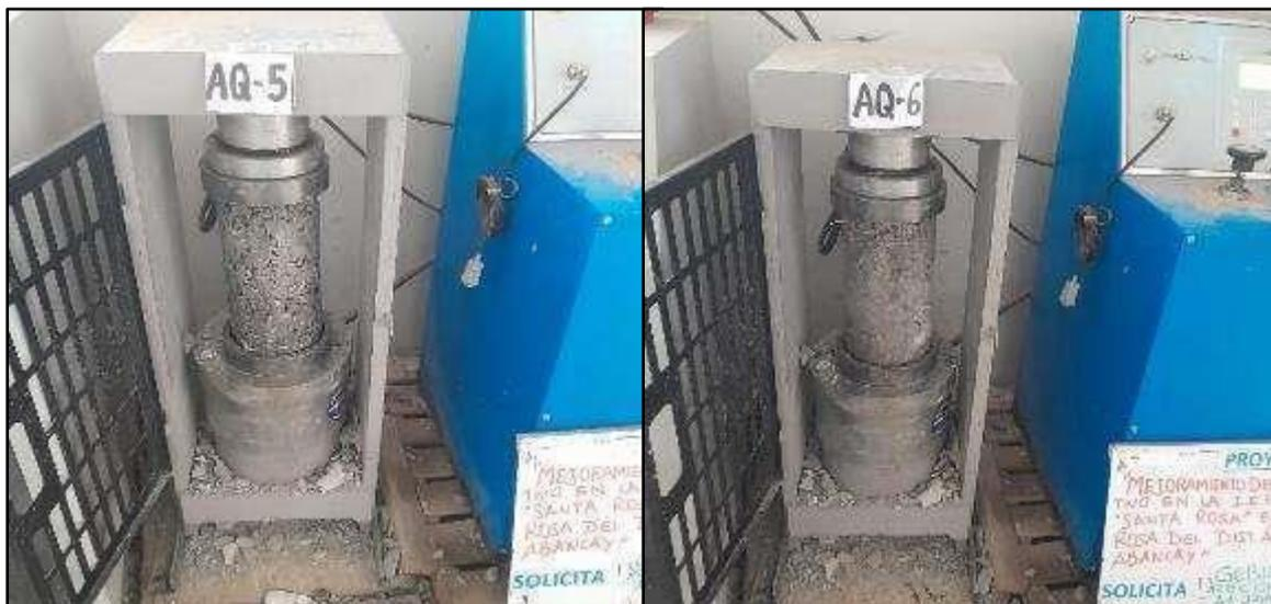
**Figura 32 — Resistencia en 28 días de roturas a compresión axial del concreto con 1% de plastómeros**
