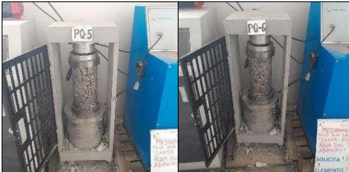
**Figura 31 — Resistencia en 28 días de roturas a compresión axial del concreto patrón**
