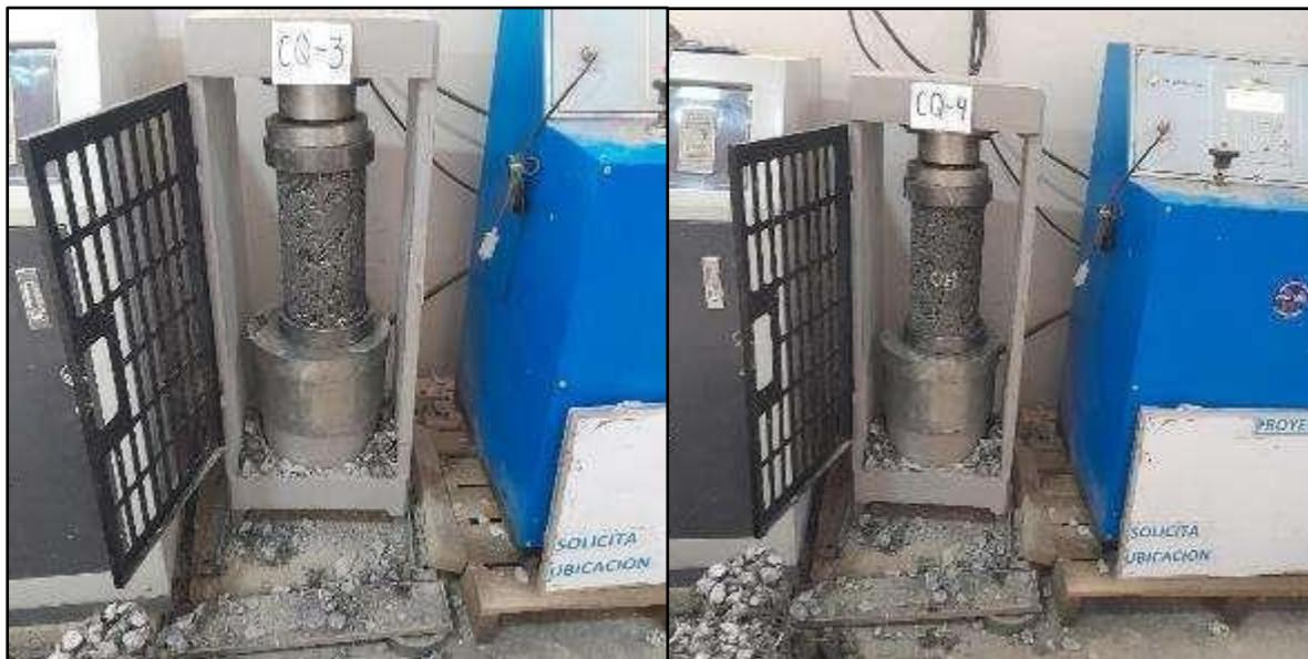
**Figura 30 — Resistencia en 14 días de roturas a compresión axial del concreto con 3% de plastómeros**
