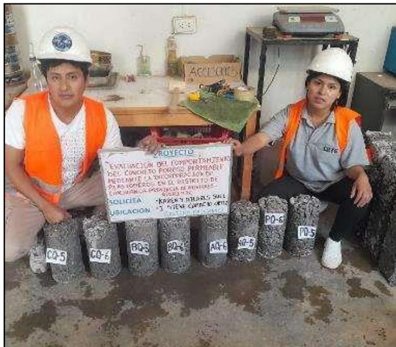
Figura 22 — Probetas de concreto para resistencia de roturas a compresión axial
