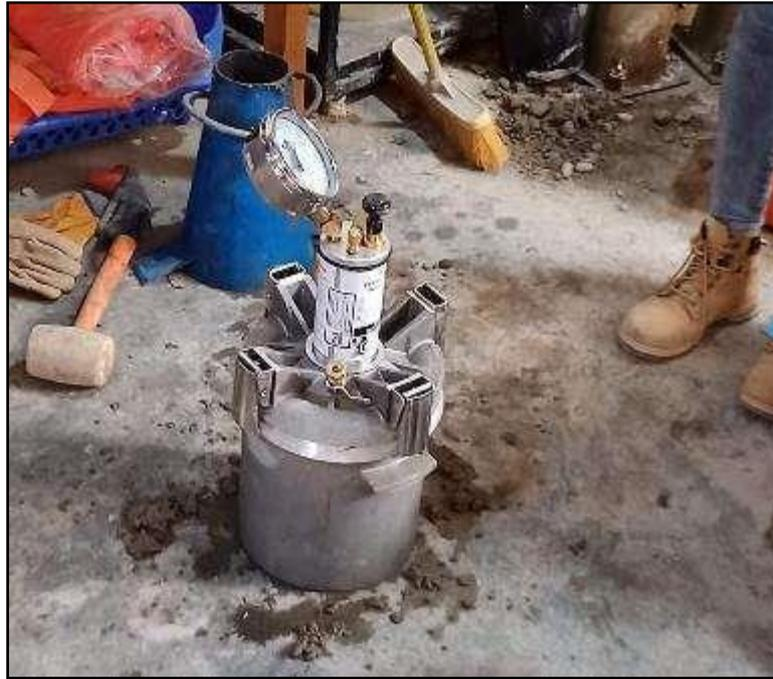
Figura 21 — Medición de contenido de aire
