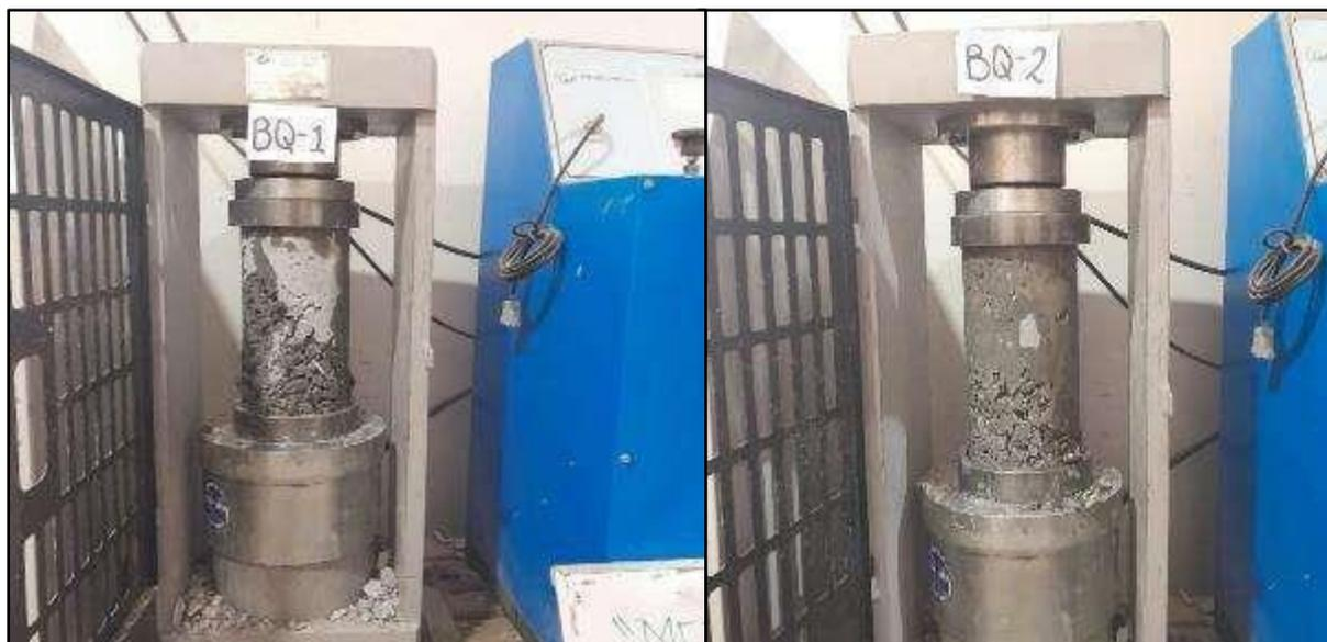
**Figura 25 — Resistencia en 7 días de roturas a compresión axial del concreto con 1.5% de plastómeros**
