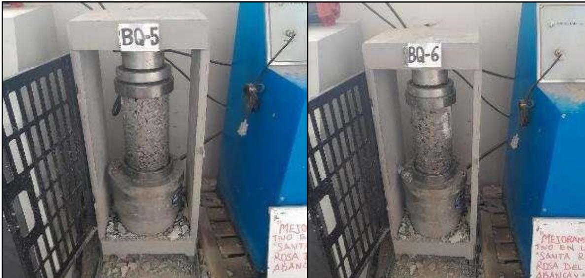
Figura 33 — Resistencia en 28 días de roturas a compresión axial del concreto con 1.5% de plastómeros
