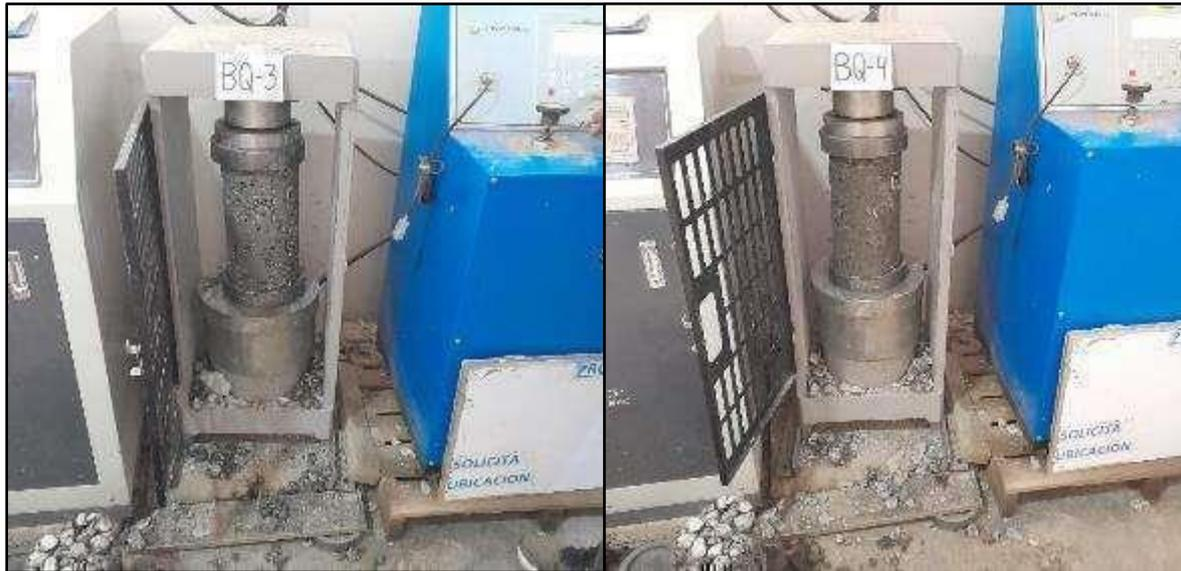
**Figura 29 — Resistencia en 14 días de roturas a compresión axial del concreto con 1.5% de plastómeros**
