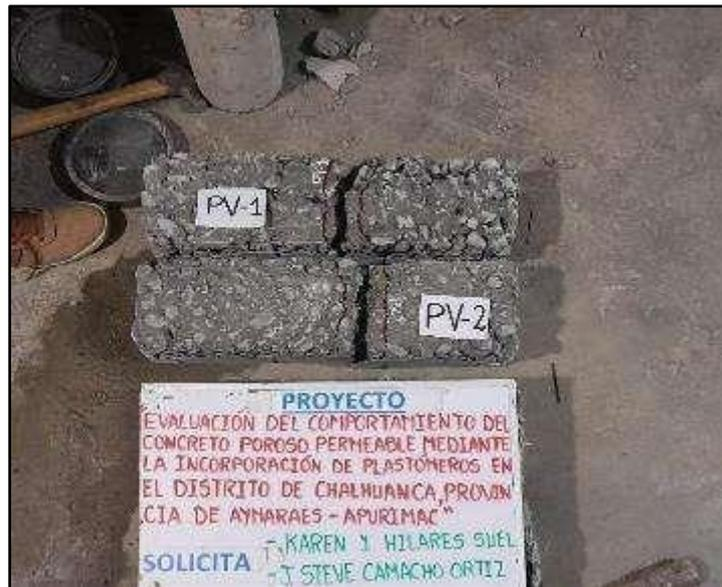
Figura 37 — Resistencia a la flexión en 7 días de vigas con cargas a los tercios del tramo, del concreto patrón
