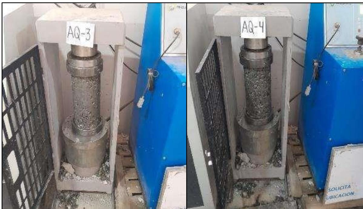
**Figura 28 — Resistencia en 14 días de roturas a compresión axial del concreto con 1% de plastómeros**
