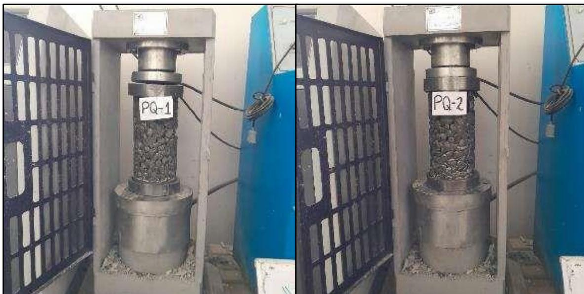
Figura 23 — Resistencia en 7 días de roturas a compresión axial del concreto patrón
