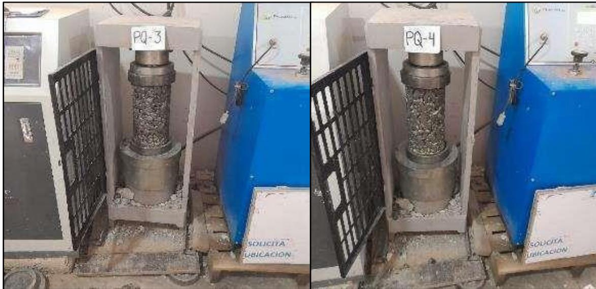
**Figura 27 — Resistencia en 14 días de roturas a compresión axial del concreto patrón**
