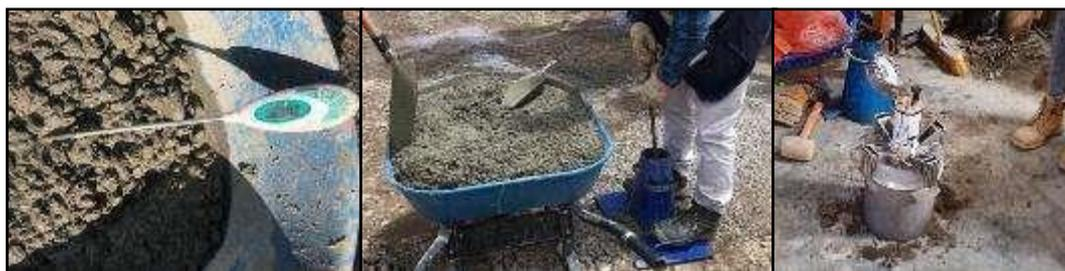
**Figura 10 — Medición de temperatura, asentamiento, contenido de aire y ensayo de peso unitario del concreto fresco**
