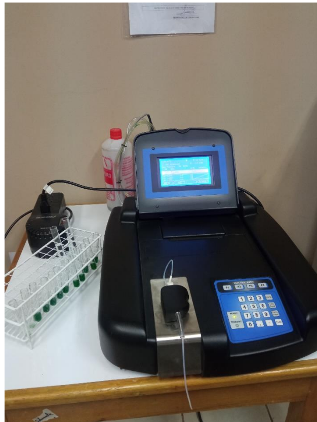
Figura 12. Analizador bioquímico semiautomatizado (Stat Fax 3300, USA)
