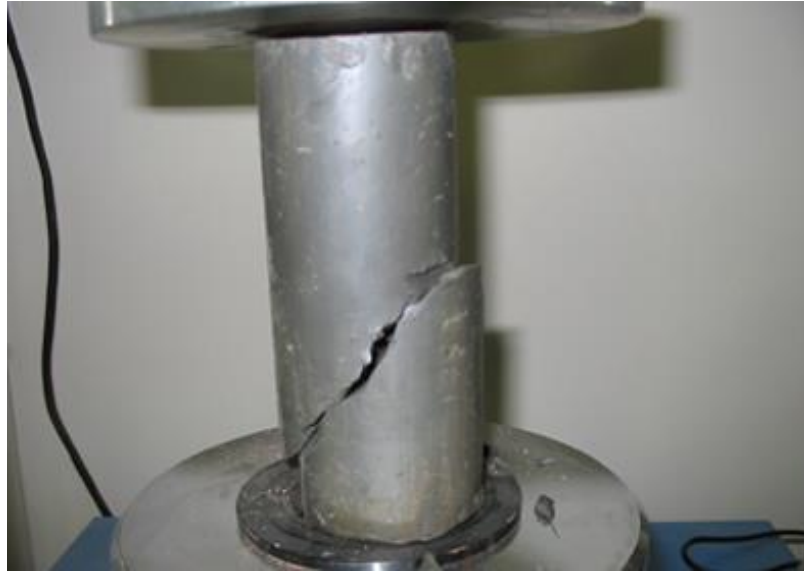
Figura 33 — Ensayo de compresión simple con prensa de carga
