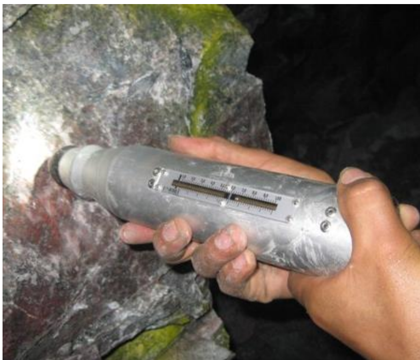
Figura 31 —Medición in situ con martillo de SCHMIDT
