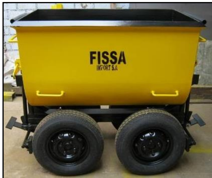
Figura 41 — vagón minero a utilizarse para el acarreo del mineral
