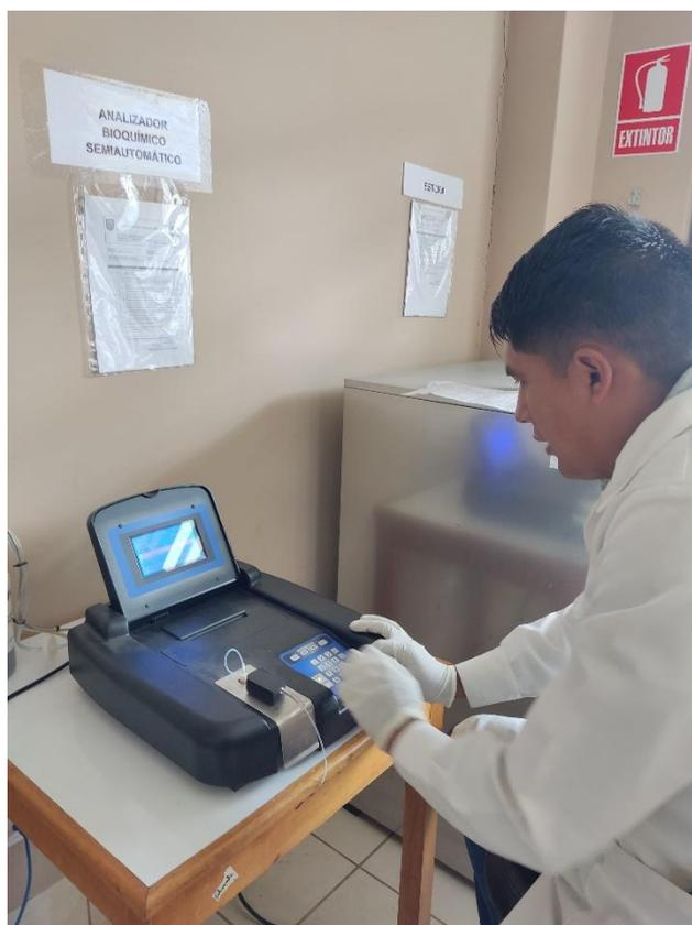
**Figura 11.** Calibrando el espectrofotómetro.
