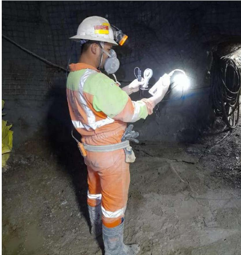
**Figura 57** — Tomando medida de gases presentes en la labor
