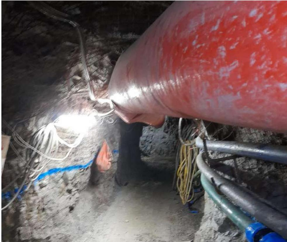
**Figura 59** — Vista de la manga de ventilación y servicios de agua
