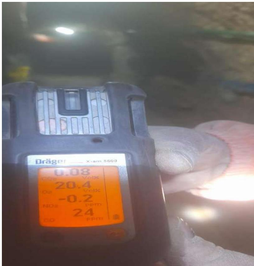
**Figura 54** — Medidor de gases Dräger que se utiliza en la Unidad Minera
