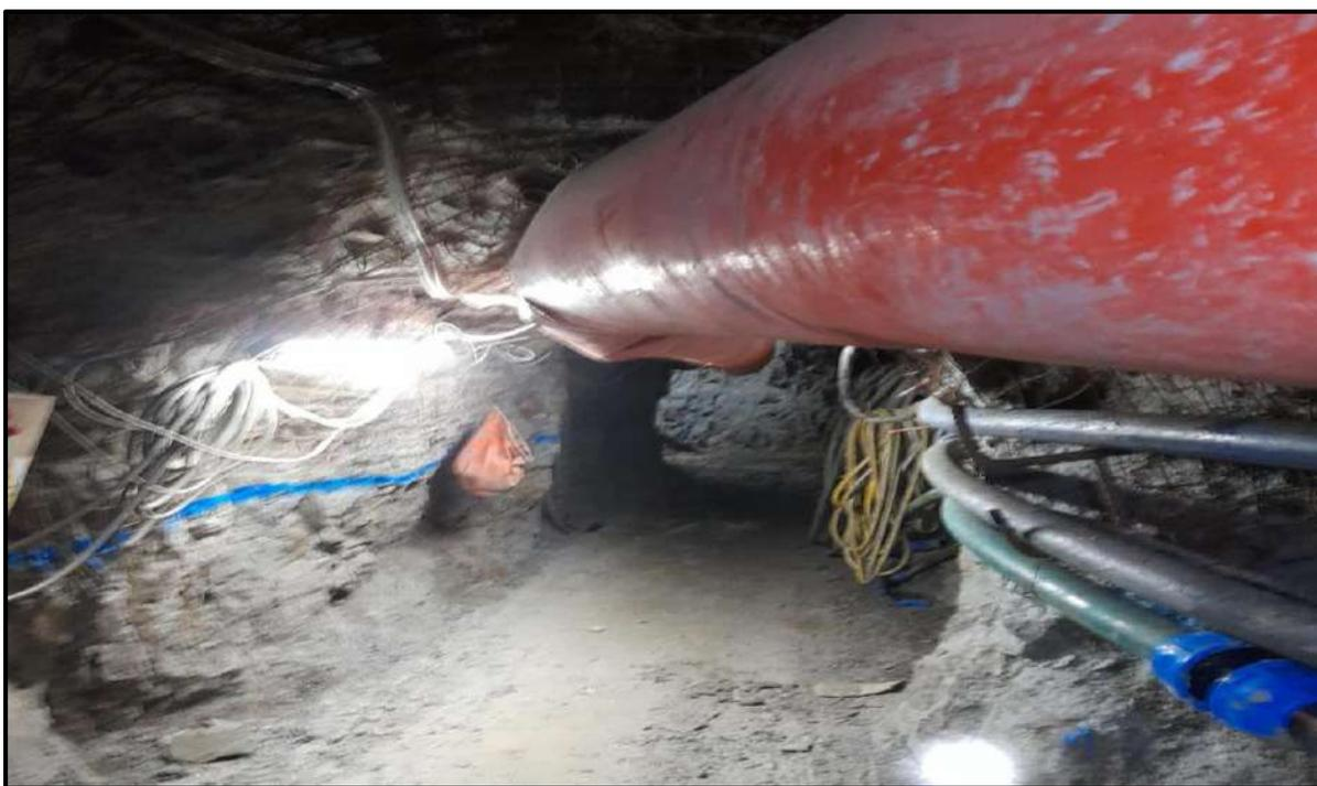
**Figura 42** — Extracción de aire contaminando mediante mangas de ventilación
