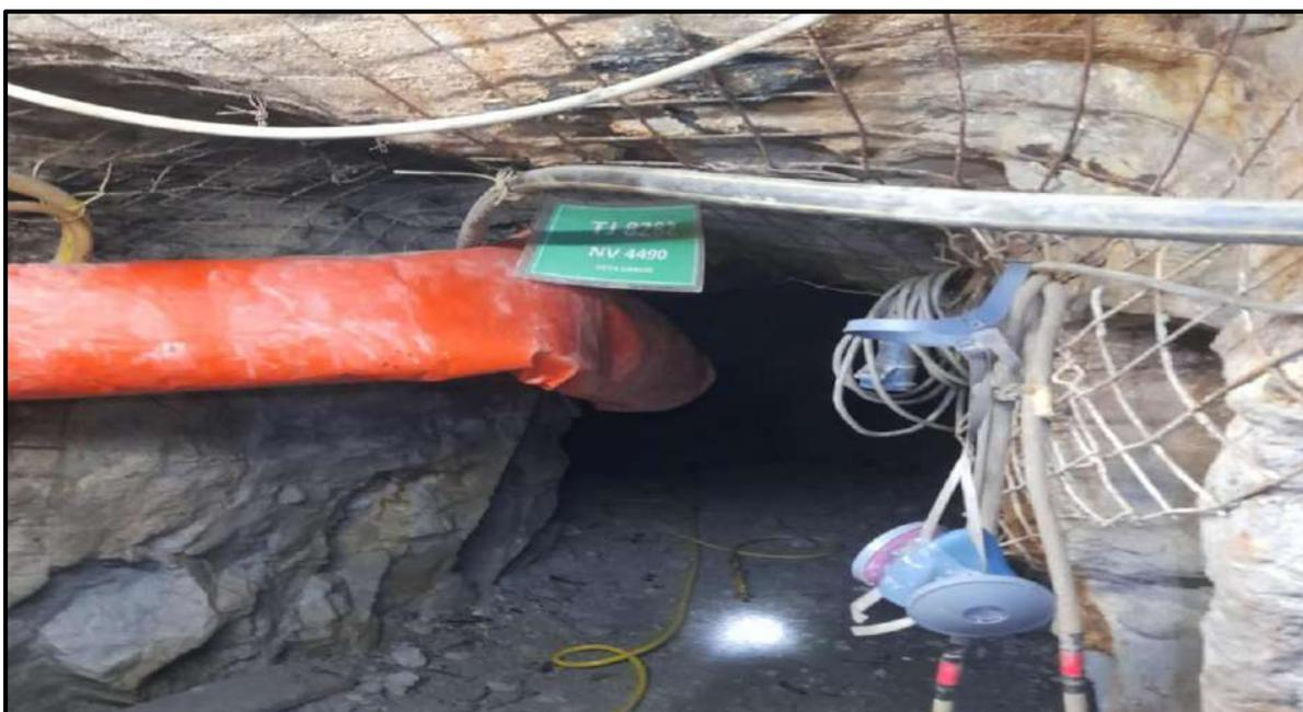
**Figura 40** — Flujo de aire al SN 4490 en manga de ventilación de 25” de diámetro
