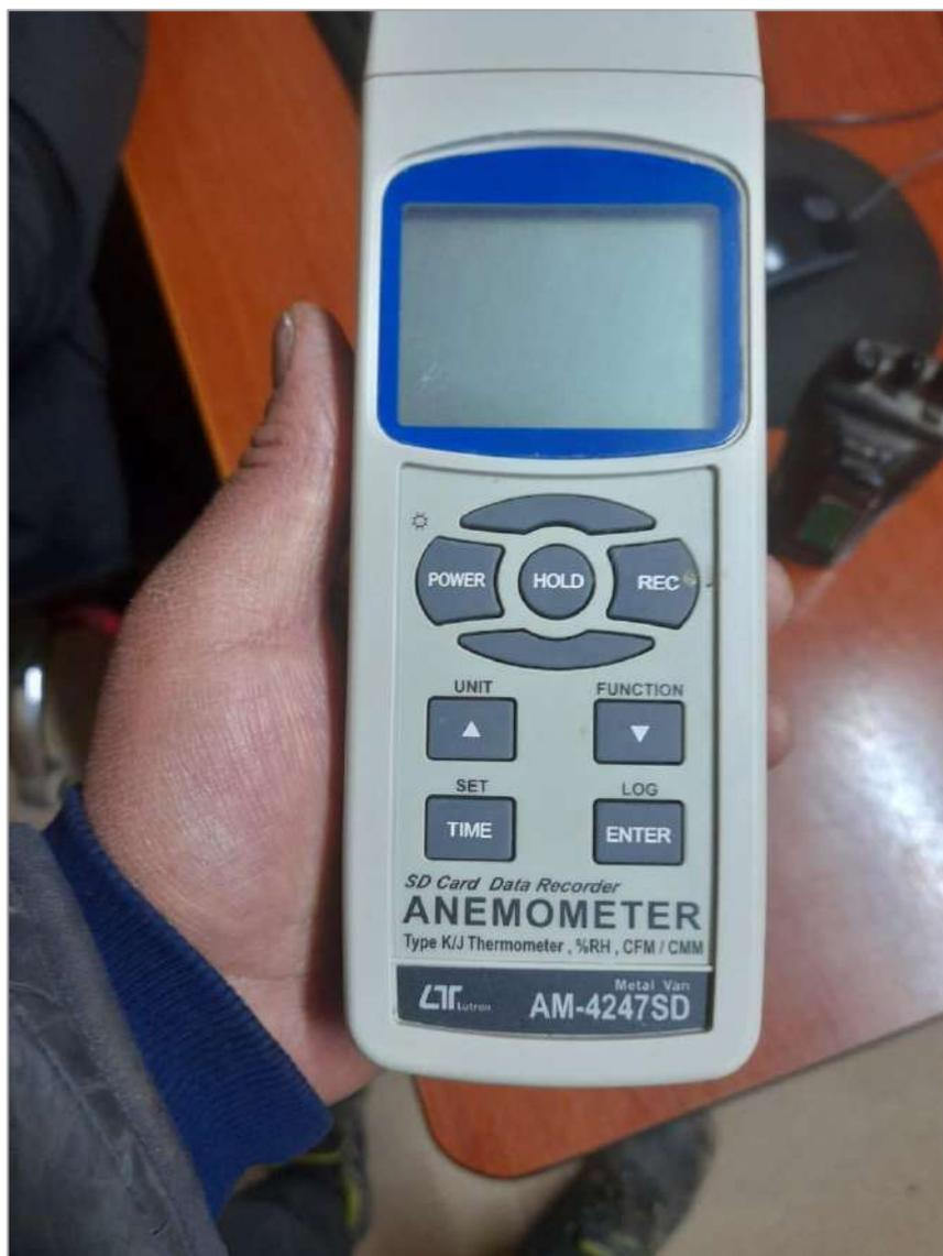
**Figura 37** — Equipo para medir la velocidad de aire (Anemómetro)
