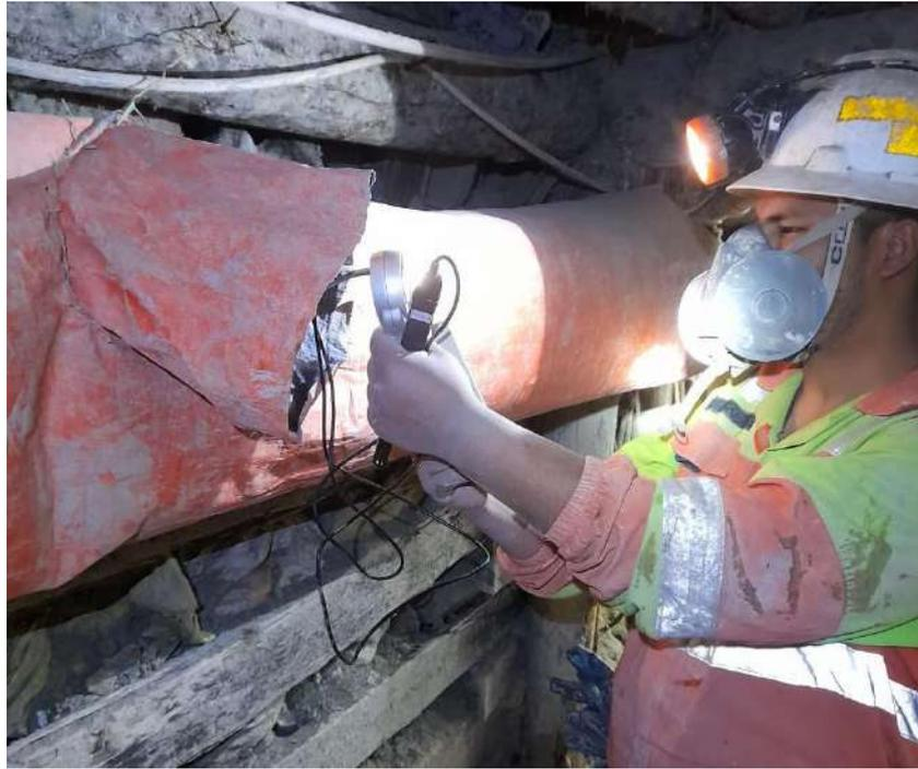
**Figura 56** — Verificando fuga de gases en la manga de ventilación
