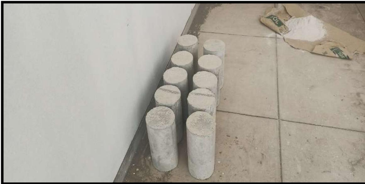
**Figura 82 — Briquetas de concreto premezclado**
