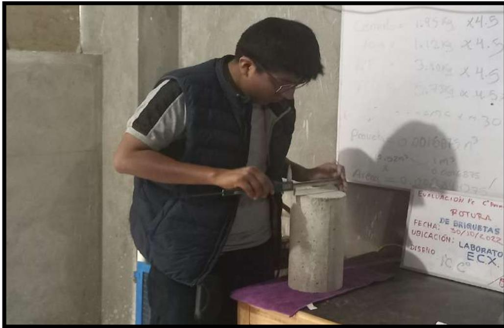
Figura 83 — Medición del diámetro de Briquetas de concreto
