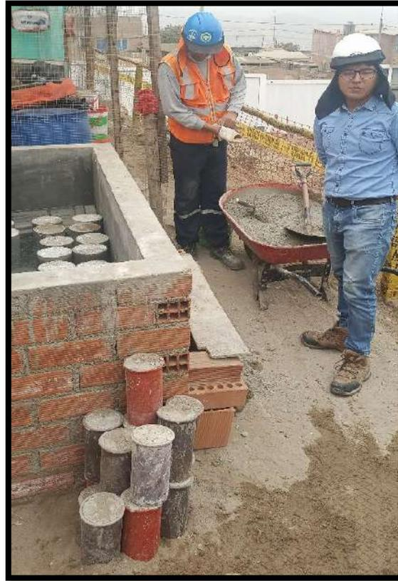
**Figura 81 — Curado de Briquetas de concreto premezclado y tradicional en el laboratorio**
