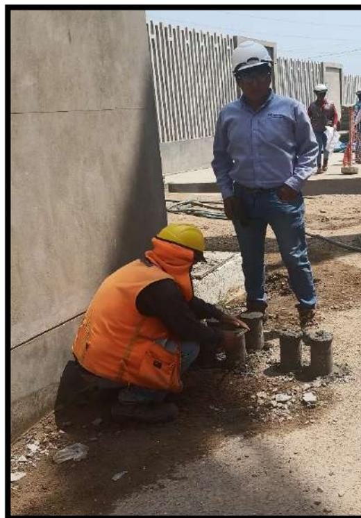
**Figura 74 — Elaboración de Briquetas de concreto premezclado en estado fresco**
