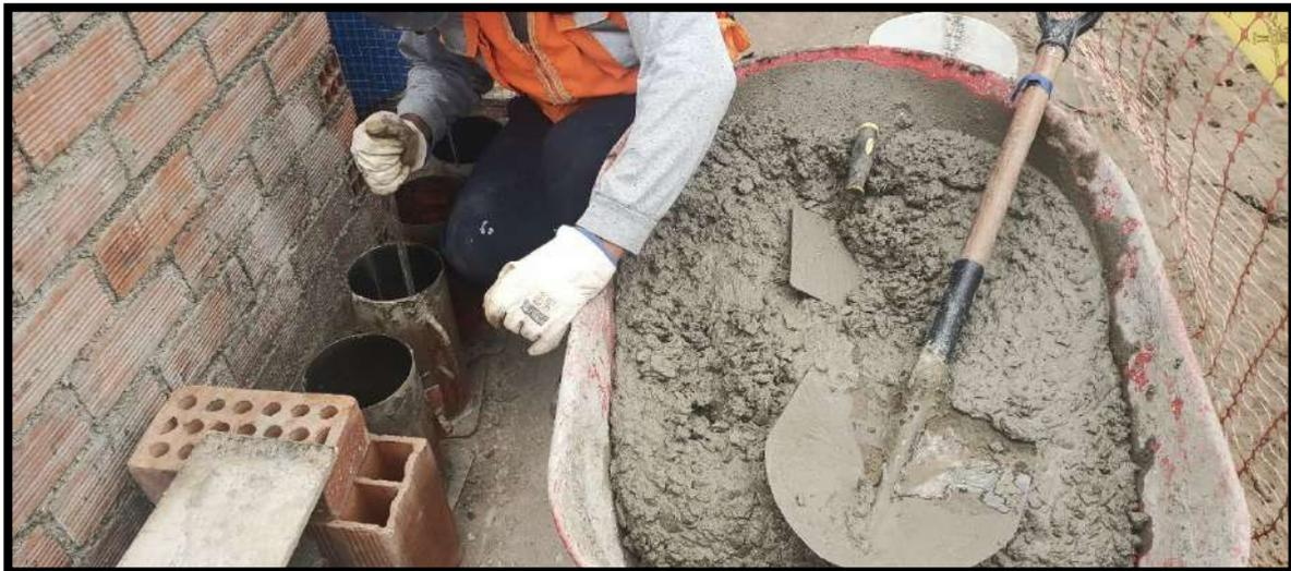
**Figura 76 — Elaboración de Briquetas de concreto premezclado en campo**
