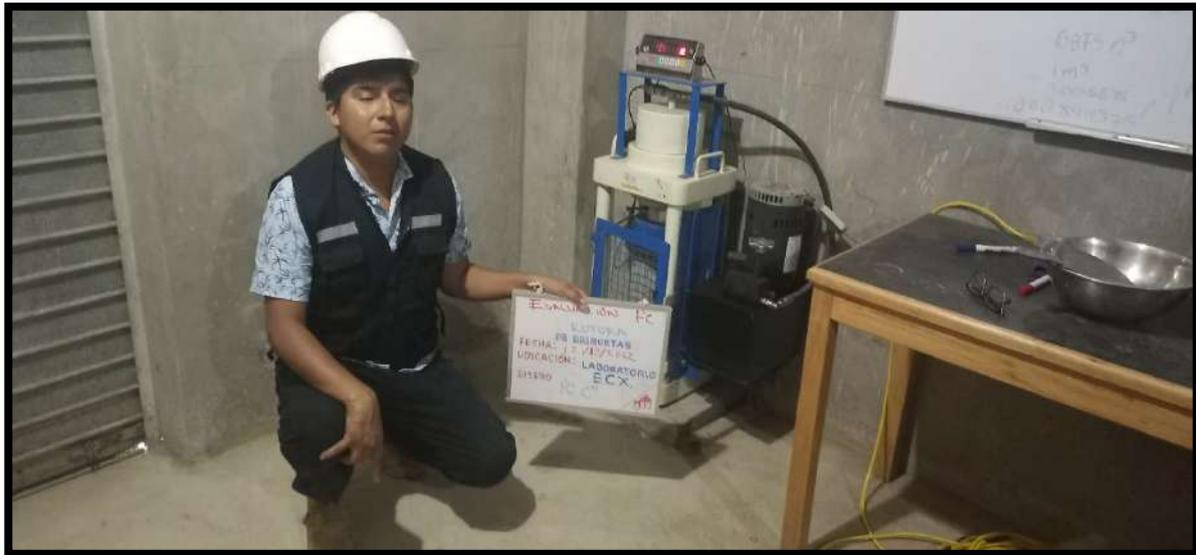
**Figura 85 — Ensayo de resistencia a la compresión de Briquetas de concreto**
