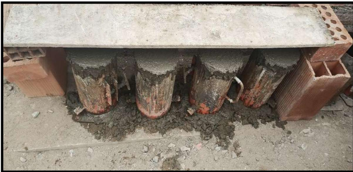
**Figura 78 — Briquetas de concreto Tradicional de la vivienda 05**
