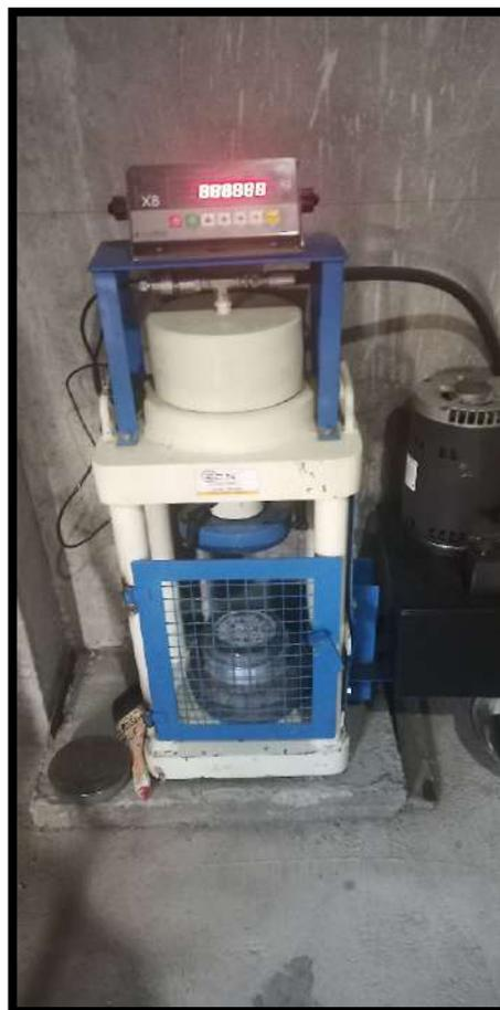
**Figura 86 — Determinación de la resistencia a la compresión del concreto tradicional**
