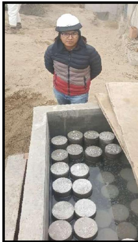
**Figura 80 — Curado de Briquetas de concreto premezclado y tradicional en el laboratorio**
