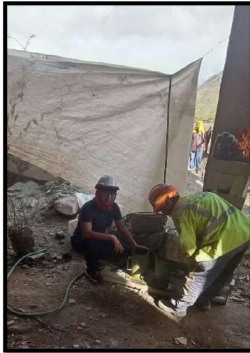
**Figura 73 — Muestreo de mezcla en estado fresco en la vivienda 02**
