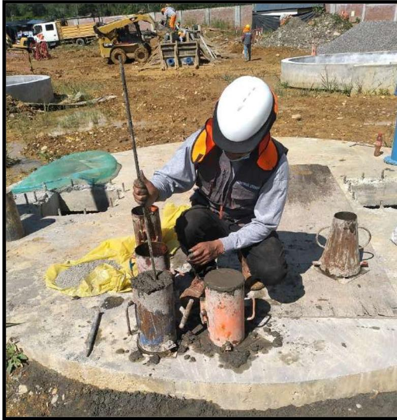
**Figura 75 — Elaboración de Briquetas de concreto premezclado en campo**
