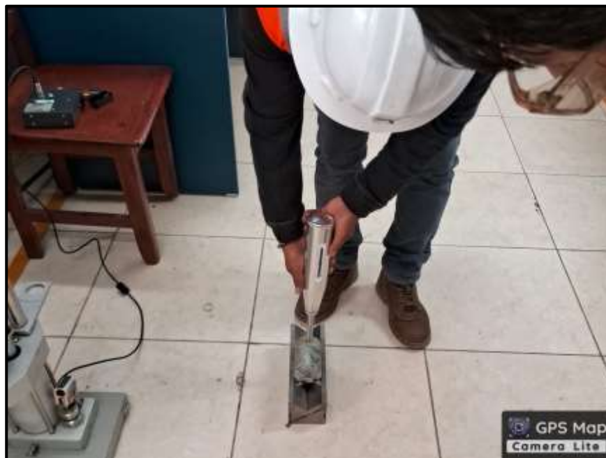
Figura 16 — Vista de la ejecución de ensayos en el laboratorio uso del martillo smith
