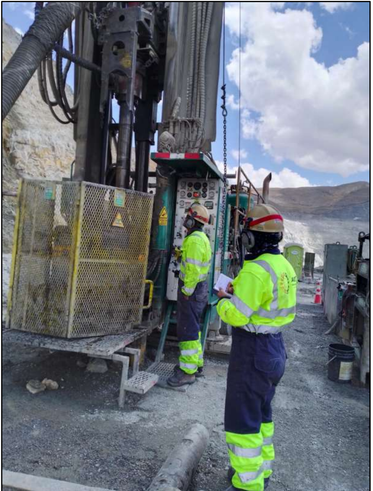
Figura 10 — Control de parametros de perforacion en el tajo ferrobamba Fase5E
