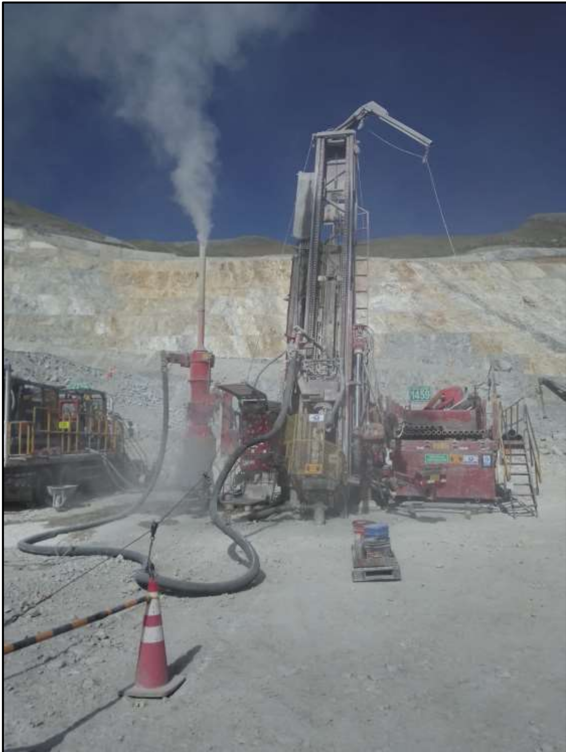
Figura 8 — Maquina de perforacion Schramm TH685 en plataforma de perforacion Tajo Ferrobamba Fase5W
