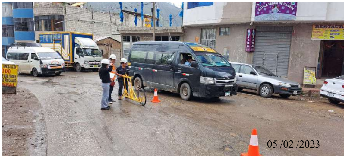
Fotografía 3 – Medición con el Rugosímetro de Merlín de las desviaciones o depresiones en el tramo 1 carril derecho en la progresiva 0+000 a 0+150.
