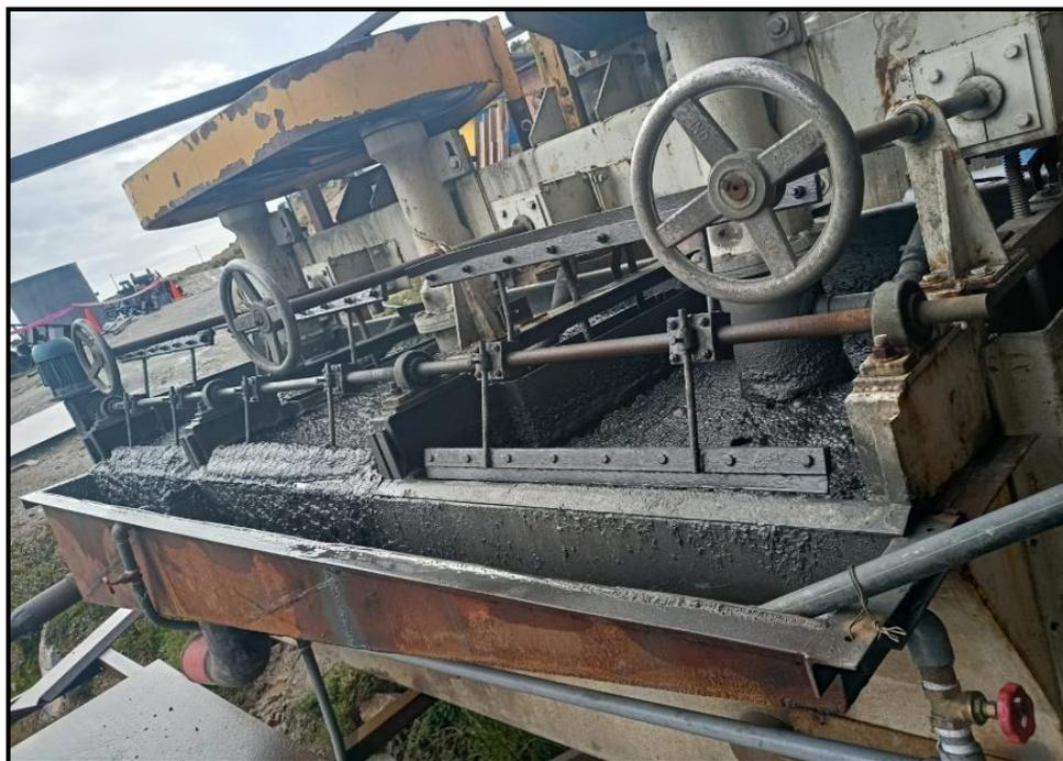
Figura 75 — Celdas de flotación estilo Denver
