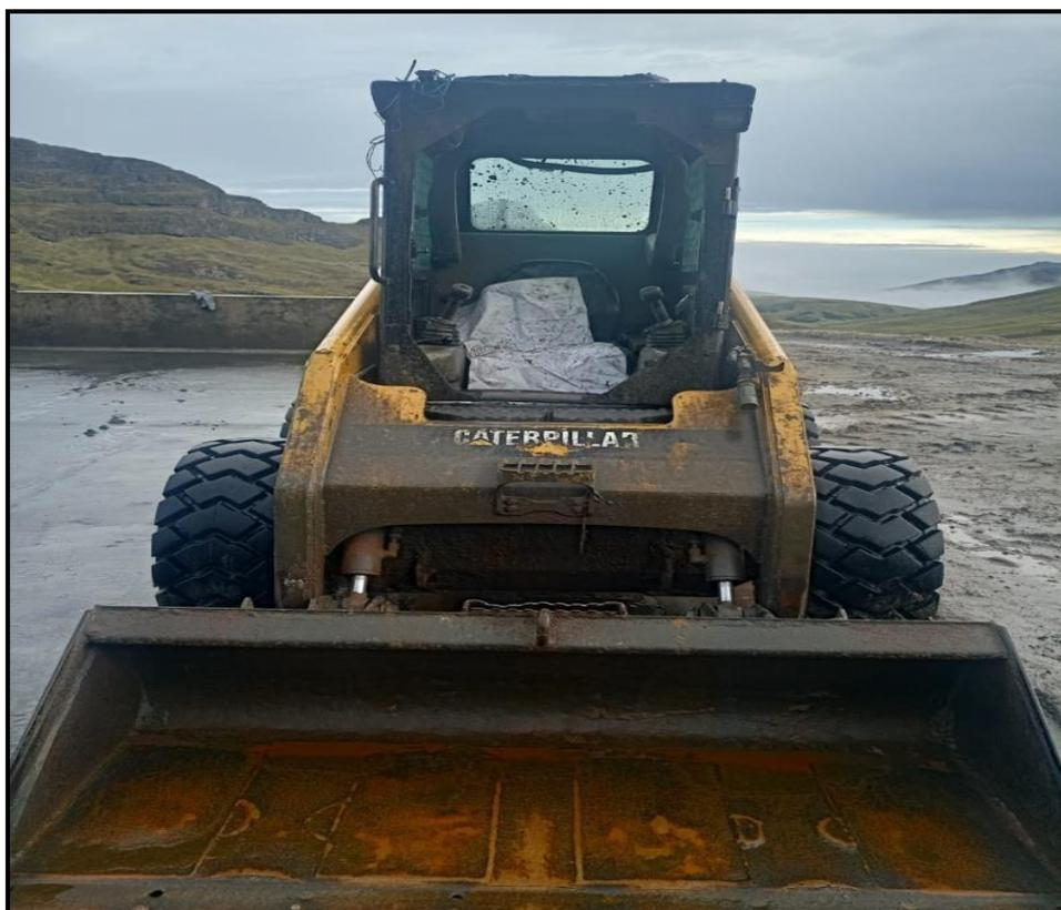
Figura 77 — Máquina Bobcat para des cochar mineral
