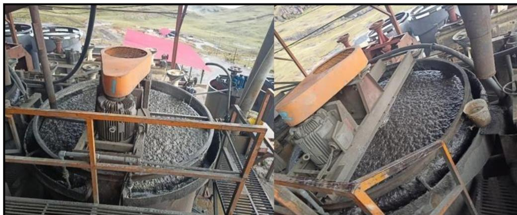
Figura 19 — Celdas de flotación WS
