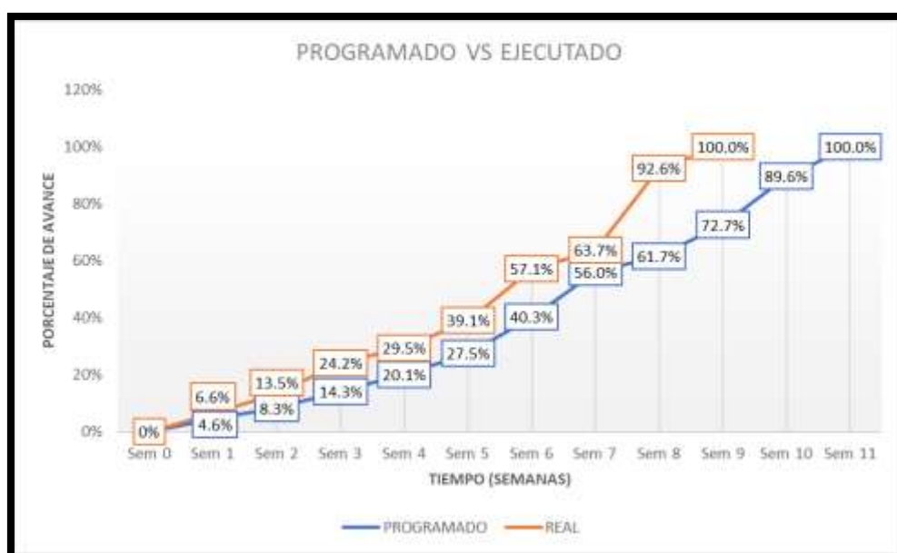
Figura 25 — Ejecución real vs programación de obra de Arquitectura, Ii. Ss. e Ii. Ee. del segundo nivel.
