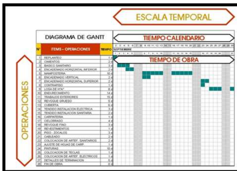
Figura 6 — Esquema de diagrama de Gantt Extraído de: (Wilde 2018)
