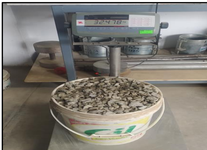
Figura 23 — Dosificación de los materiales para la elaboración del concreto
