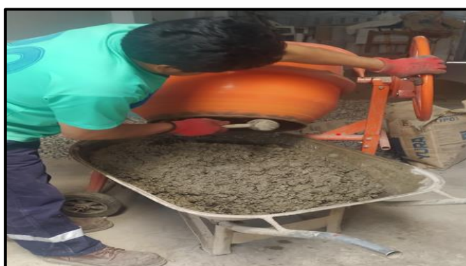
Figura 25 — Control de temperatura en estado fresco del concreto
