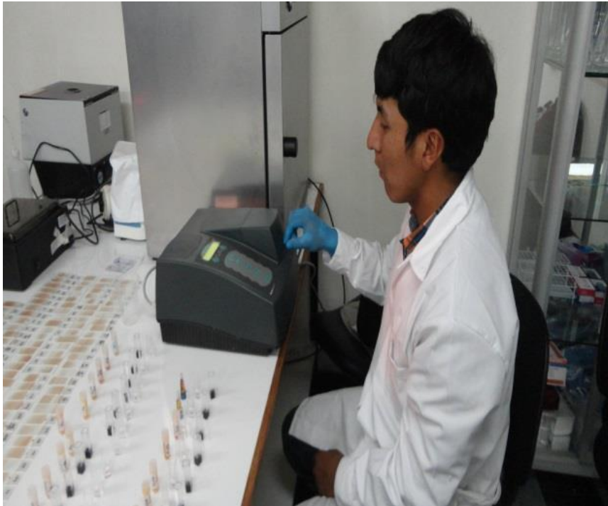
Fotografía 13c. Lectura en espectrofotómetro.
