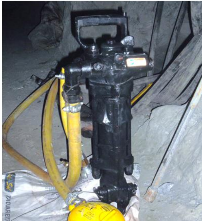
Ilustración 2: Perforadora neumática Jackleg
