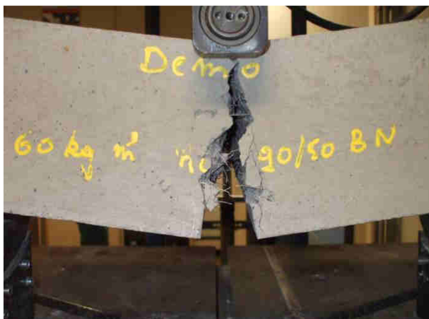
Figura N° 28.- Anclaje de la fibra metálica, capaz de trabajar una vez roto.
