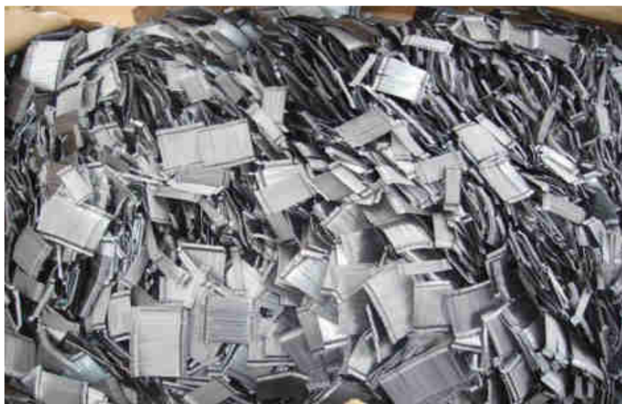
Figura N° 27.- Fibra metálica encolada 65/35, para shotcrete vía húmeda. Fuente: (Elaboración propia).
