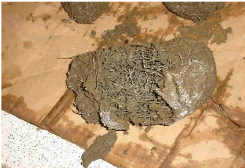
Figura N° 29.- Formación de bolas o erizos, por el tipo de fibra inadecuada.
